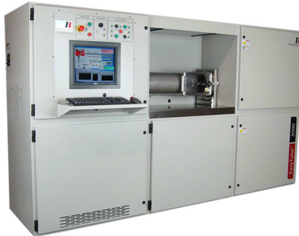
FIGURE 2.1 – Équipement CVD FirstNano EasyTube TM 3000
