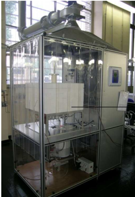
FIGURE 5.7 – Banc d'essai utilisé pour caractériser les performances des cellules SOFC
