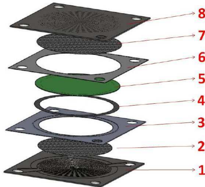
FIGURE 5.15 – Schéma d'un élément de base d'une pile SOFC développé au Politecnico di Torino
