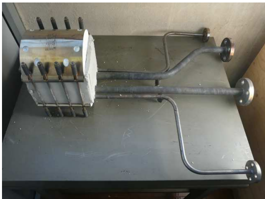
FIGURE 5.25 – Pile 1\text{ kW}_{el} fournie par TOP-SOE
