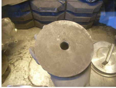
FIGURE 3.2 – Composite d'hydrure de magnésium produit par McPhy Energy
