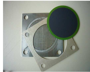
FIGURE 5.4 – Photographie d'une cellule SOFC commercialisée par HC Starck Ceramics [13]
