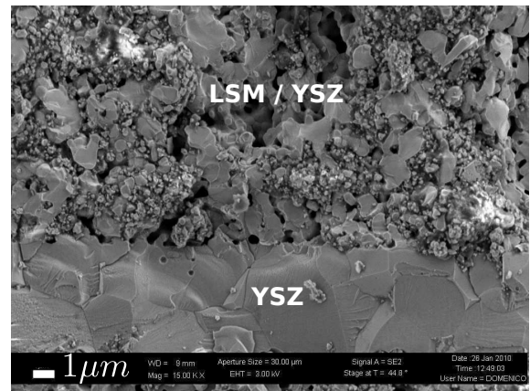
FIGURE 5.22 – Image MEB d'une section de cellule après 300 h de fonctionnement avec CROFER 22 APU
