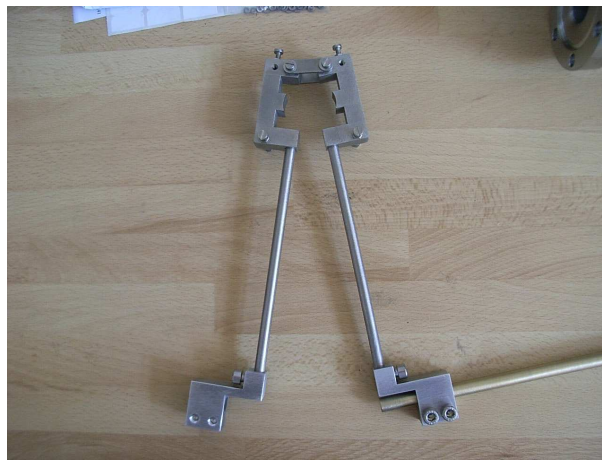
FIGURE 2.29 – Système d'amplification du déplacement
