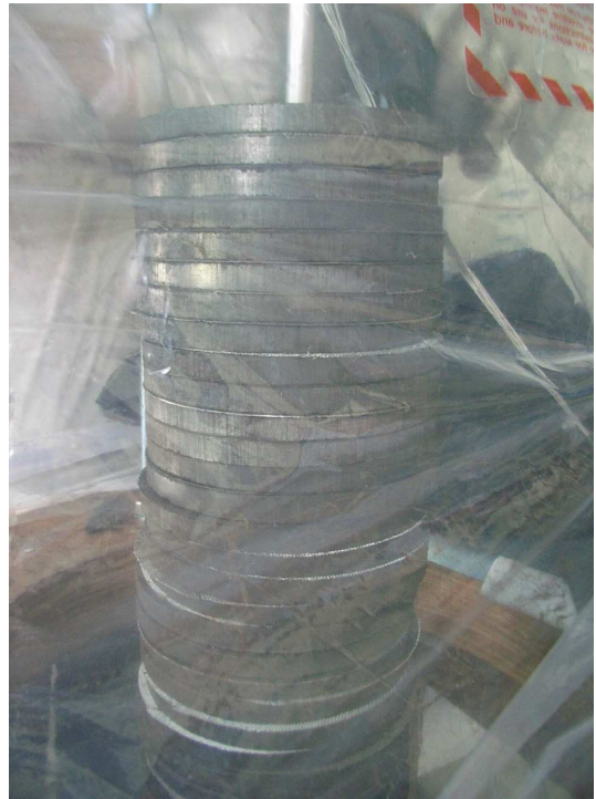
FIGURE 3.7 – Empilement des composites et des grilles métalliques sous atmosphère protectrice
