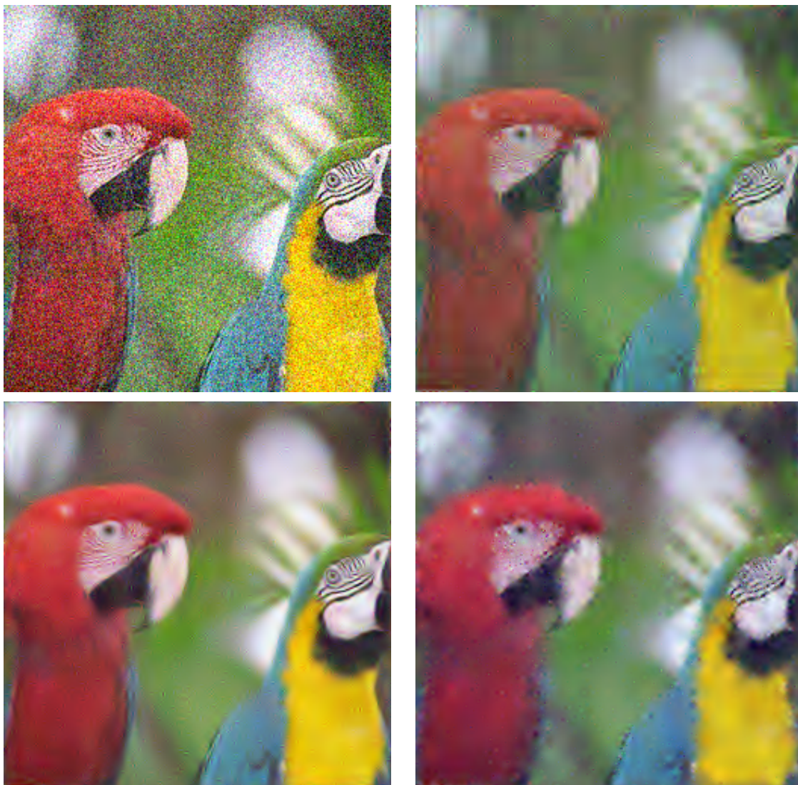
FIGURE 3.15 – Débruitage de l'image parrot . Première ligne : Image bruitée, débruitage par ondelettes orthogonales. Seconde ligne : débruitage par ondelettes non-décimées, approche proposée.
