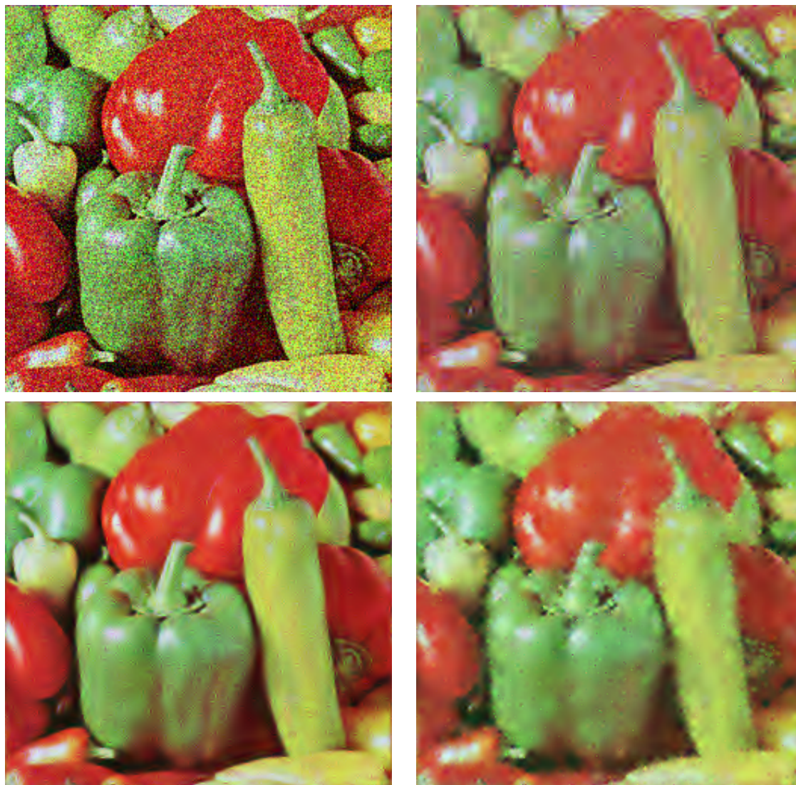
FIGURE 3.14 – Débruitage de l'image peppers . Première ligne : Image bruitée, débruitage par ondelettes orthogonales. Seconde ligne : débruitage par ondelettes non-décimées, approche proposée.
