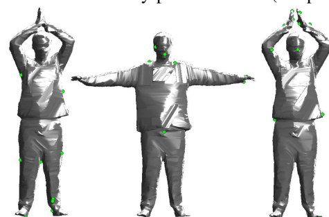
(d) Harris3D sparse key-point detection (setup I).
