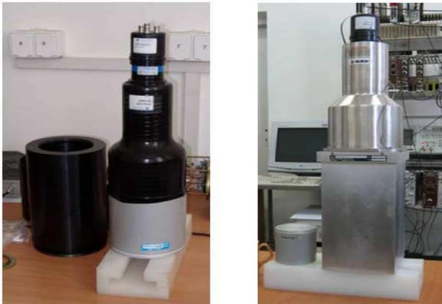
Figure I - 30. Détecteurs gamma NaI(Tl) 5"x5" (à gauche) et 5"x5"x10" (à droite) [69].
