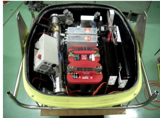
Figure I - 24. Système sous-marin d’inspection des explosifs SURVEYOR [61] [60], utilisé pour les premiers essais de faisabilité du système UNCOSS.
