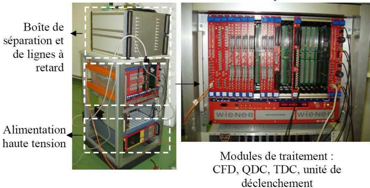
Figure I - 32. Electronique d’acquisition et de traitement de signal [69].
