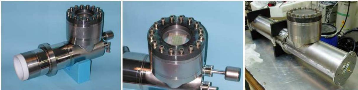
Figure I - 28. Générateur de neutrons à particule associée [69].
