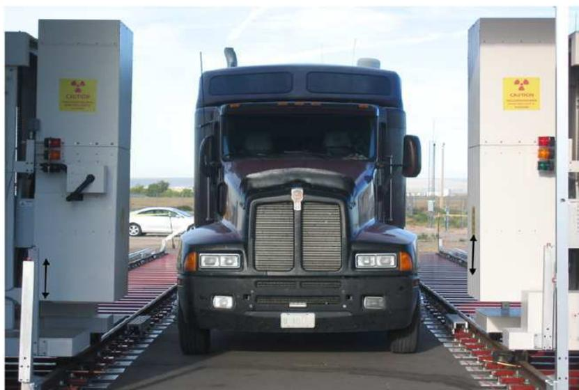
Figure I - 8. Système d’inspection des camions pour la recherche des explosifs. Le conteneur est scanné des ses deux coté par deux générateurs de neutrons pulsés [38].
