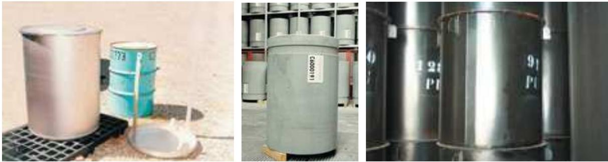
Figure IV - 1. Fût métallique d'enrobé bitumineux et surfût inox EIP (à gauche), conteneur béton fibres cylindrique CBFC'2 (au milieu) et conteneurs métalliques (870 L) de déchets solides [113].
