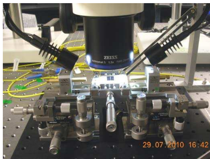
Fig. I.9 Photo du montage de caractérisation montrant le dispositif sous test (DUT), les micro-positionneurs et le microscope optique.
