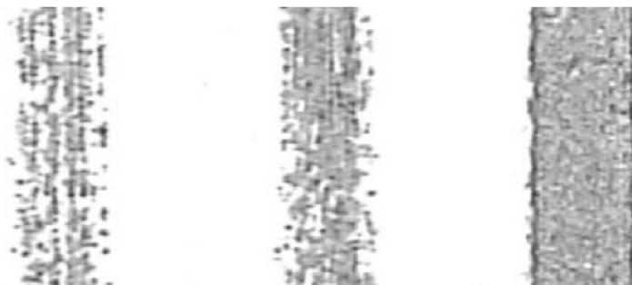
Figure 11 : Images au microscope optique de trois essais de rayure sur verre en utilisant un laser nanoseconde ultraviolet. De gauche à droite, le taux de répétition des pulses a été augmenté et la vitesse de balayage a été diminuée.
