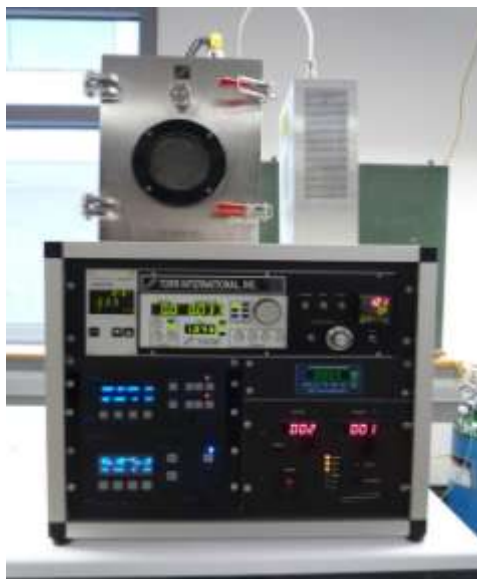
Fig. 3-2 : Photographie du système de pulvérisateur cathodique magnétron rf qui sera utilisé dans ces recherches.
