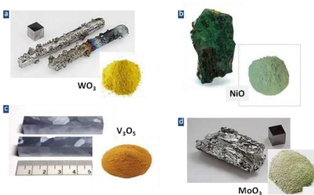
Fig. 2-14. Représentation des quatre principaux matériaux semi-conducteurs de type-p employés dans le photovoltaïque organique sous leurs formes brute et oxydée : (a) \text{WO}_3 ; (b) \text{NiO} ; (c) \text{V}_2\text{O}_5 ; (d) \text{MoO}_3 .
