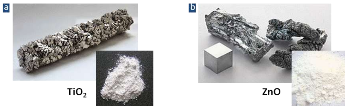
Fig. 2-15. Représentation des deux principaux matériaux semi-conducteurs de type-n employés dans le photovoltaïque organique sous leurs formes brute et oxydée: (a) \text{TiO}_2 ; (b) \text{ZnO} .
