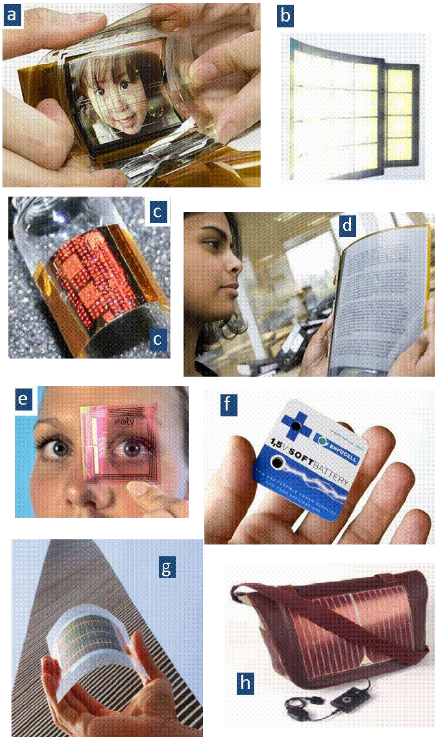
Fig. 1-2. Exemples de dispositif de l'électronique organique : (a) afficheur flexible à OLED ; (b) Luminaire à OLED [Philips]; (c) étiquettes et packaging intelligent ; (d) e-paper [LG flexible e-paper displays] ; (e) étiquette RFID [Poly-IC] ; (f) batterie organique ultra fine [enfuCELL softvattery] ; (g) et (h) modules photovoltaïques organiques pour intégration au bâtiment et applications embarquées respectivement [Konarka Power Plastics]
