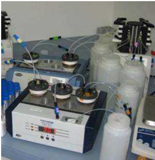
Figure 41. Photographie du dispositif expérimental employé lors des expériences de dissolution réalisées en conditions dites « dynamiques » et schéma du réacteur employé (d'après Dacheux et al. 46 ).
