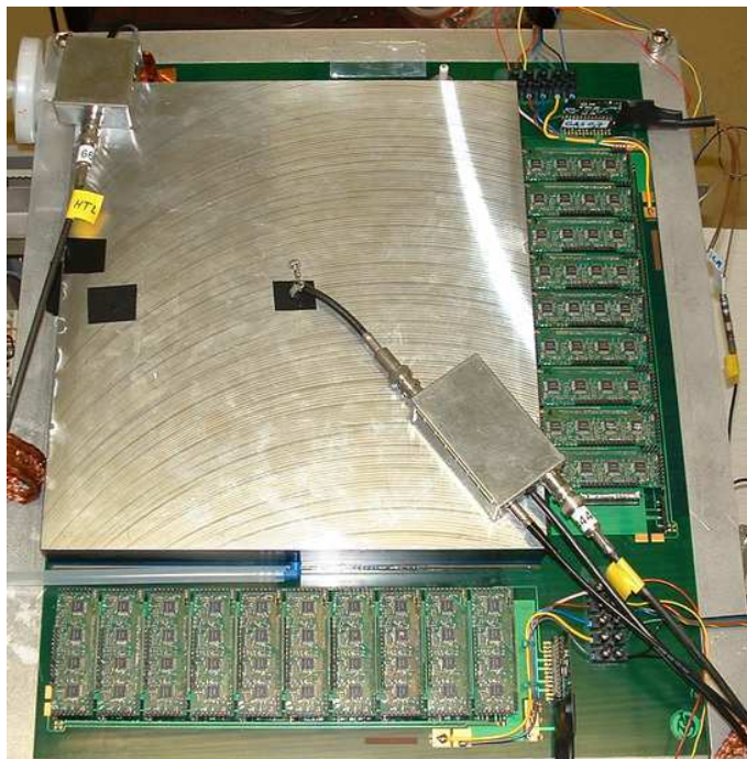
FIG. 1.9 – Premier prototype d'imagerie \beta développé au laboratoire Subatech.
