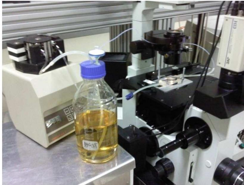
**Figure 6.1 : Système d'écoulement pour le développement de biofilm. Pompage par pompe péristaltique**
