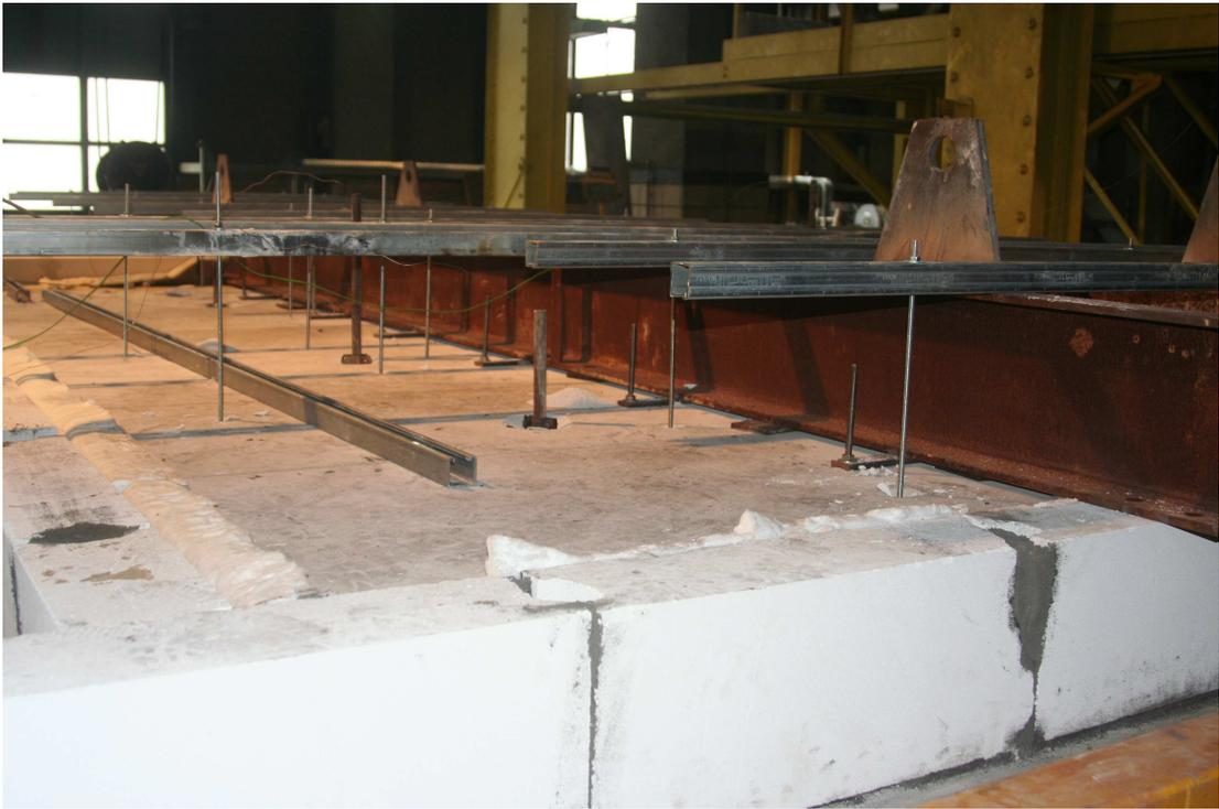
*Photo V-1 : Vue de dessus du four, suspensions du conduit à l'aide de tiges filetées.*
