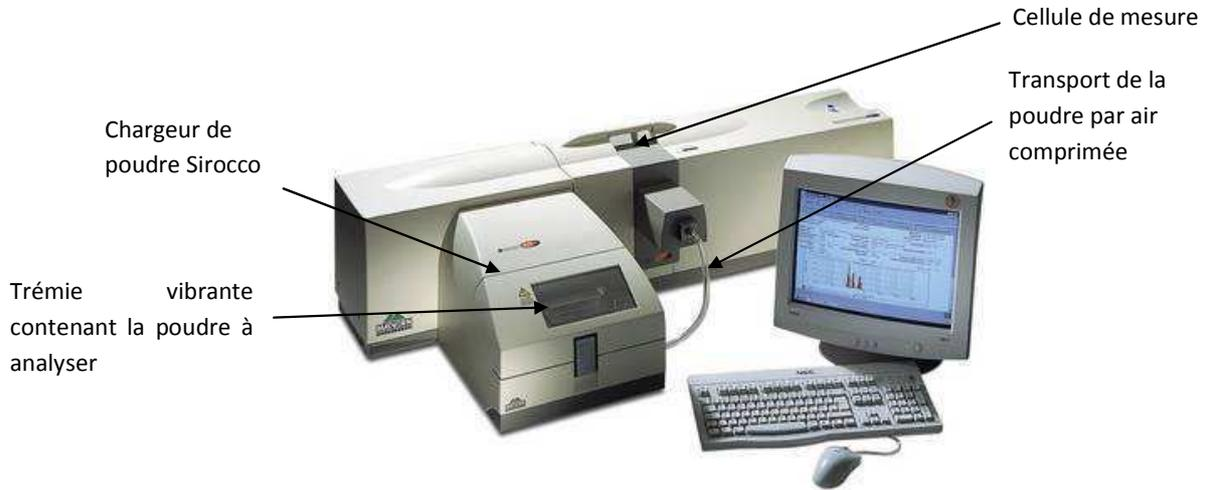
Figure II-2 : Granulomètre laser pour l'analyse de poudre sèche.
