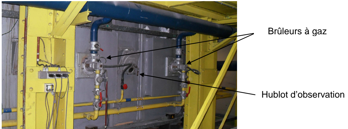
Photo V-3 : Photo de deux brûleurs à gaz servant à simuler l'incendie dans le four.
