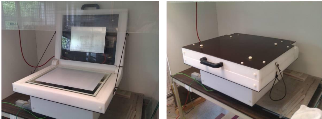
Figure III.3. Machine Fibroline à l'échelle laboratoire pour imprégnation à sec
