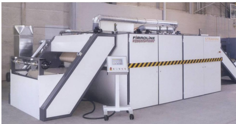
Figure III.2. Machine de pré-imprégnation à sec "Fibroline"
