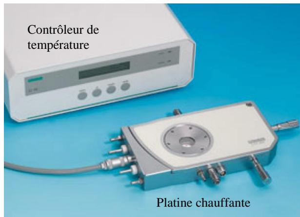
**Figure III.15.** Contrôleur de température et platine chauffante utilisées pour le suivi de cristallisation du polypropylène en présence de fibres de chanvre
