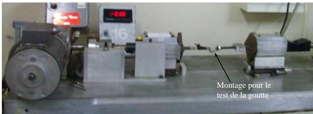
Figure III.10. Montage utilisé pour réaliser le test de la goutte
