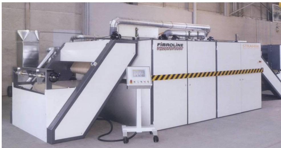
**Figure III.2.** Machine de pré-imprégnation à sec "Fibroline"
