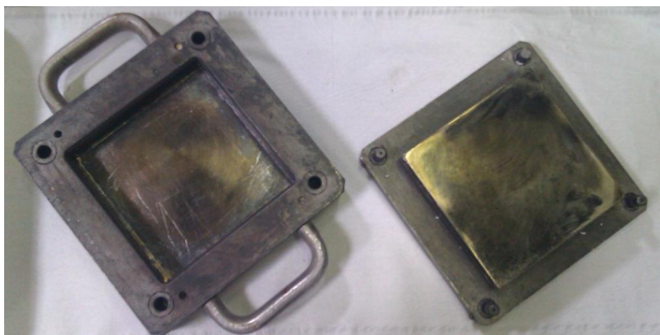
Figure III.6. Moule 15x15 utilisé par la fabrication de plaques PP/chanvre, partie inférieure (gauche), partie supérieure (droite)
