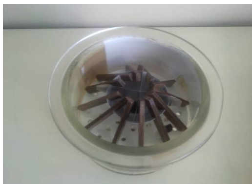
Figure III.12. Disposition des échantillons pour vieillissement en humidité relative
