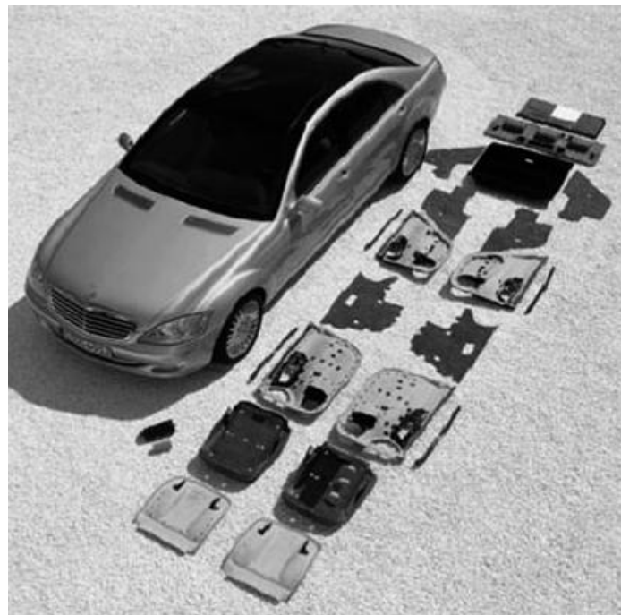
Figure I.1. Pièces de Mercedes Classe S fabriquées à partir de différents matériaux composites renforcés de fibres naturelles
