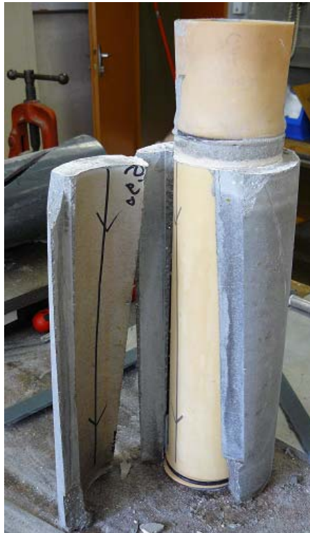
Photographie de la carotte de COx après démontage de la cellule T1. Elle est maintenue dans une chaussette en caoutchouc et entourée de béton.
