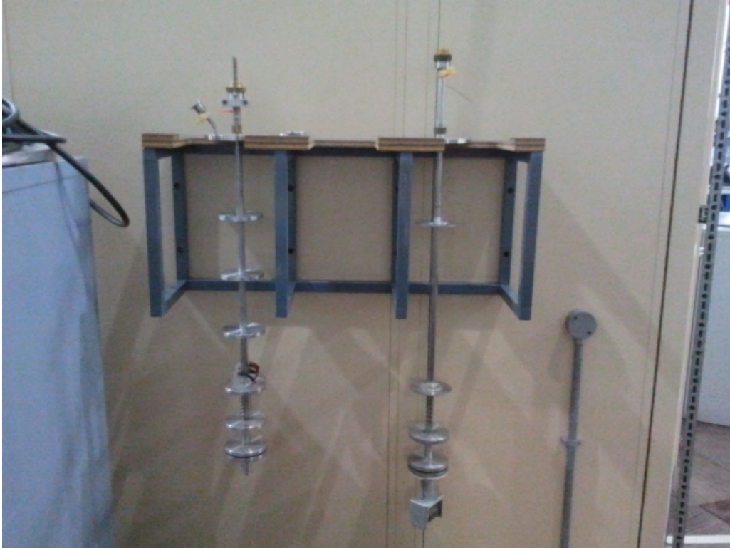
Photographie de la canne utilisée pour les essais de diffusion quasi-élastique de neutrons au bout de laquelle est placée la cellule en aluminium avec l'échantillon
