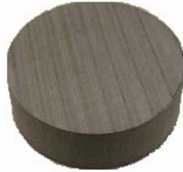
Figure 46: Echantillon de COx utilisé pour les essais de transport ( d = 30 mm et e = 10 mm)
