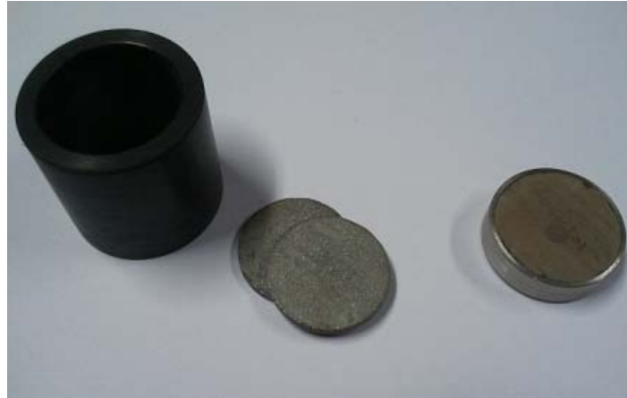
Systèmes de maintien testés pour la saturation : (de gauche à droite) chaussette en Viton avec les frittés en acier inoxydable – anneau en acier autour d'un échantillon de CO x
