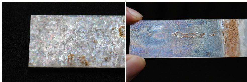
FIG. 4.12: Vernis synthétique : photo de deux plaques témoin, mises avec les grains de sable lors du vernissage artificiel. Les reflets irisés indiquent la présence du vernis. La plaque de gauche a aussi servi aux photos de la fig. 4.5 .
