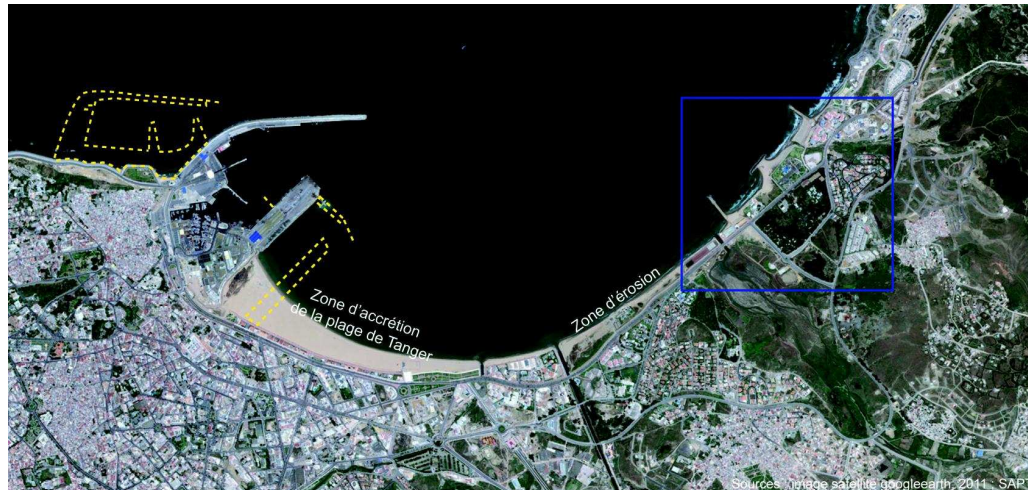
Baie de Tanger avec projection des principaux remblais du nouveau port
