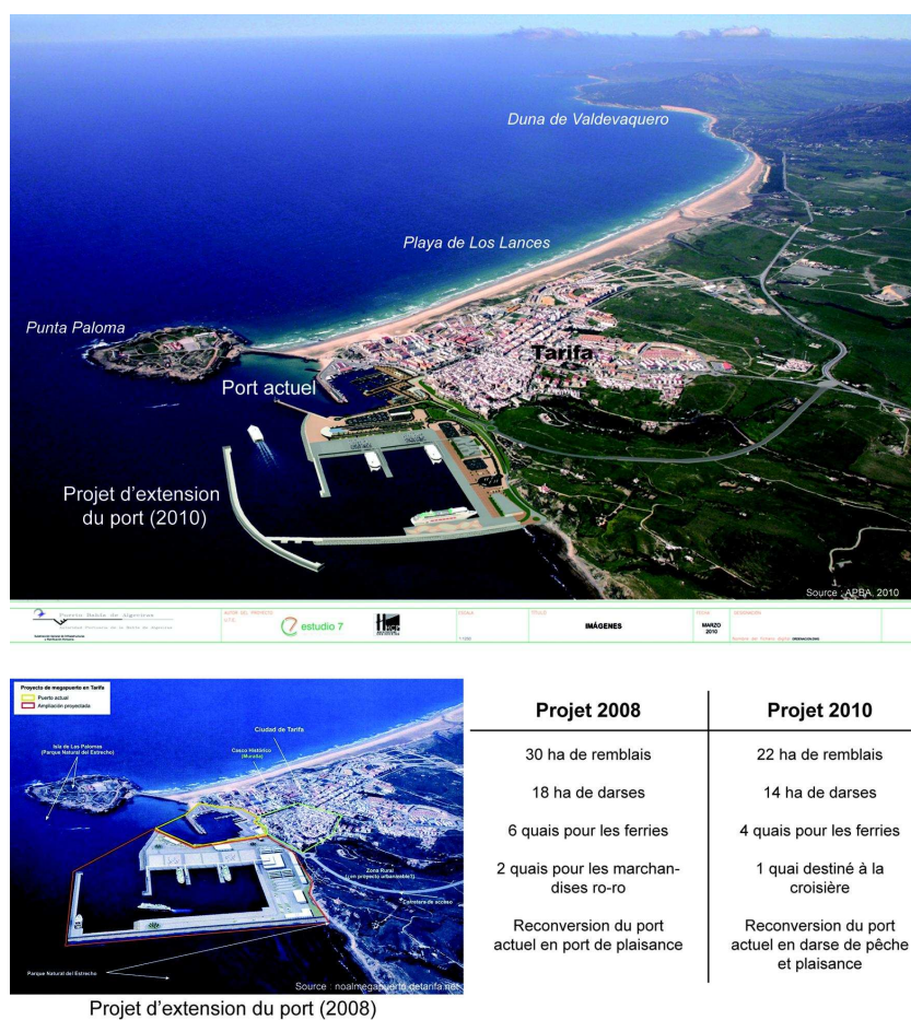
Figure IV.9 – Les projets d'extension du port de Tarifa.
