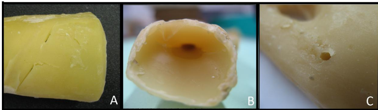
Figure 53 : A- fissuration dans les parties minces d'une douille de pointe de lance en cire. B-creux traversant l'entonnoir du modèle de hache fenestrée étroite en cire. C- trou situé dans la lame du modèle de hache fenestrée étroite en cire.
