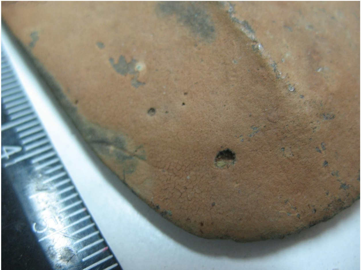
Figure 4 : zone supérieure d'une face de la lame présentant des trous de fonderie inclinés et obliques par rapport à l'axe de la hache ainsi qu'une rayure au niveau du tranchant.
