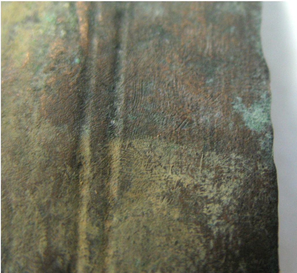
Figure 8 : observation de plusieurs stries ou rayures sur la lame.
