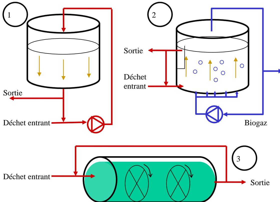
Figure 8 : Schéma de principe des principales technologies de digestion par voie sèche.
