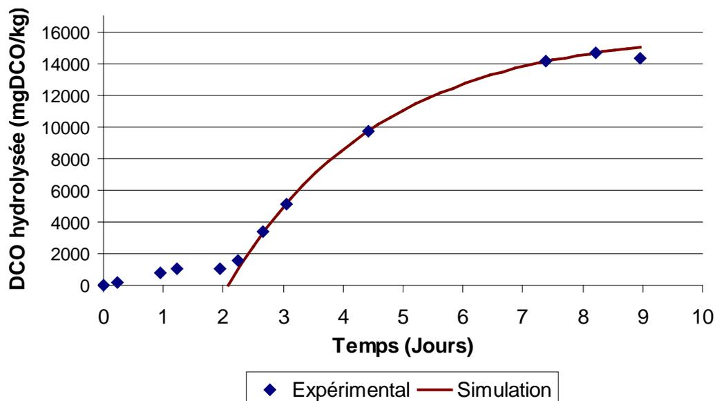
Figure 74 : Mesures expérimentales et simulations de la quantité de DCO hydrolysée au cours du temps.
