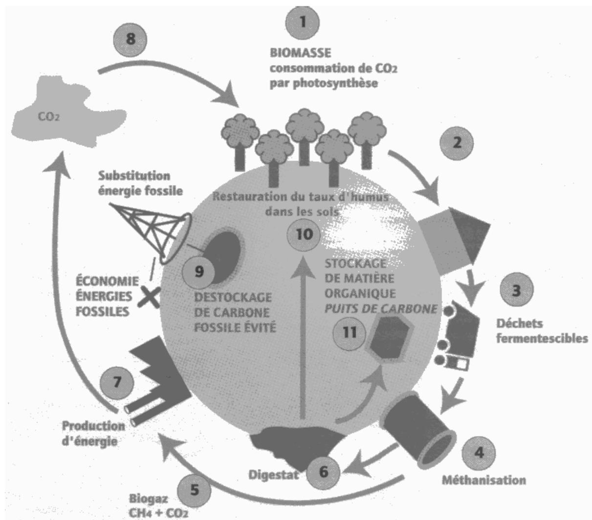
Figure 2 : La méthanisation dans le cycle du carbone.
