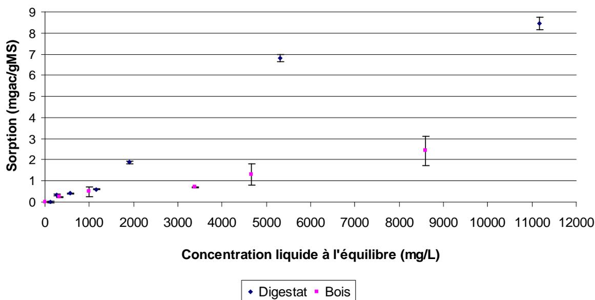
**Figure 16 : Sorption de l'acide valérique sur digestat industriel en fonction de la concentration à l'équilibre en phase liquide à 20°C et comparaison avec le bois.**
