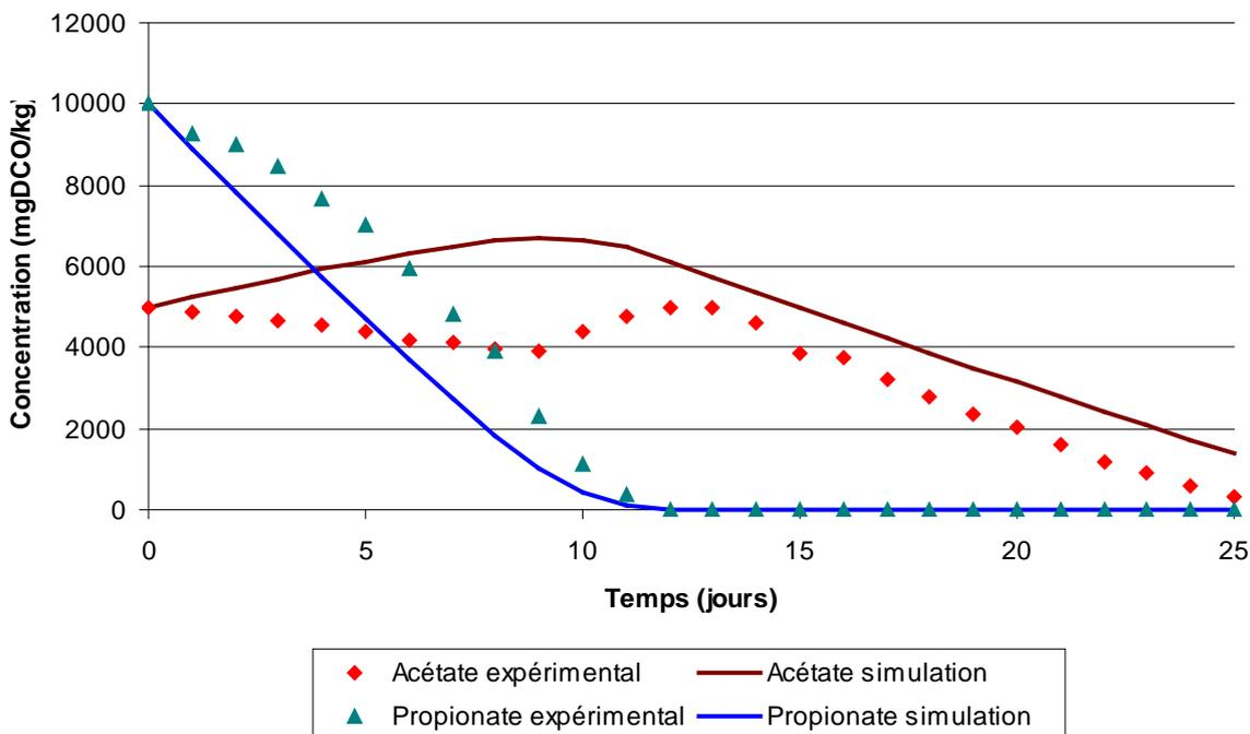
Figure 55 : Données expérimentales et simulations sur R3 avec les paramètres déterminés sur R1.
