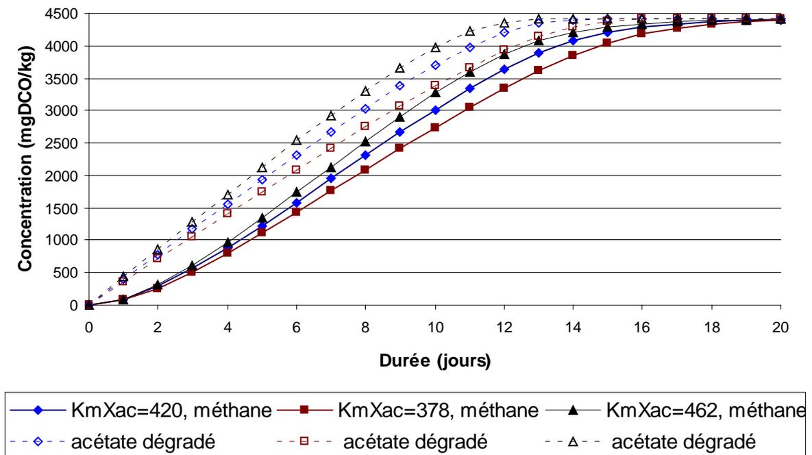
Figure 43 : Sensibilité du  $k_m X_{ac}$  à faible  $k_{L,a}$  : comparaison entre méthane gazeux formé et acétate dégradé.
