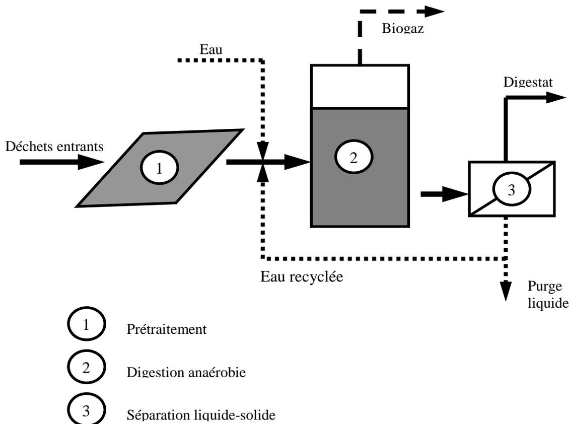
Figure 7 : Schéma général d'une installation de méthanisation.
