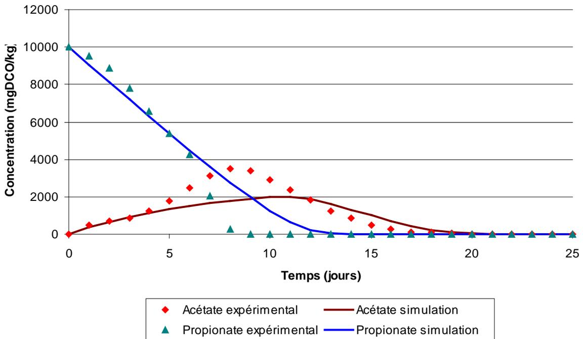
Figure 53 : Données expérimentales et simulations sur R1.
