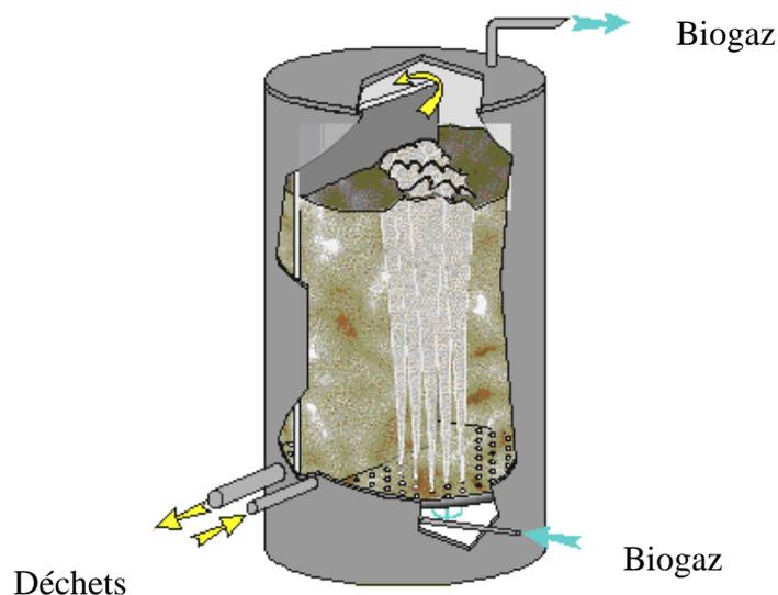
**Figure 9 : Principe de fonctionnement d'un digesteur anaérobie de type VALORGA.**
