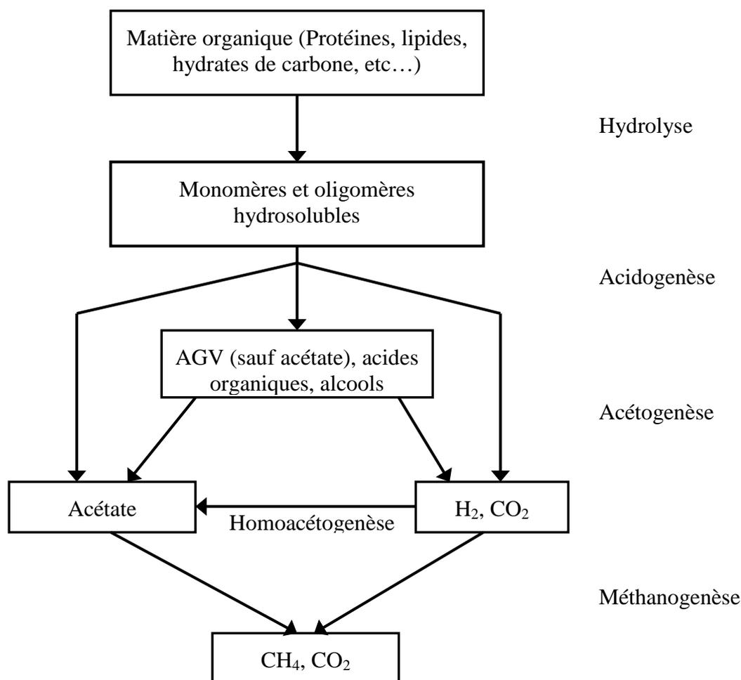
Figure 1 : Principaux flux métaboliques de la digestion anaérobie.
