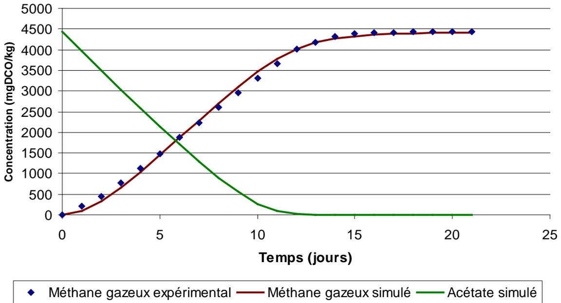
Figure 64 : Méthanogenèse acétoclastique à 18 % MS ; méthane et acétate.
