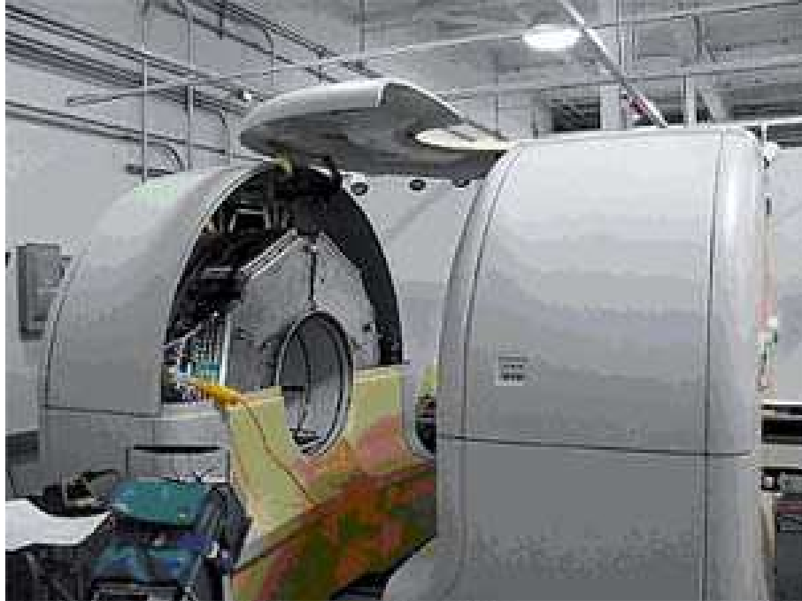
FIG. 1.4: Cette photo représente la partie PET d'un imageur Philips Gemini ouverte. On distingue les cartes électroniques connectées aux tubes photomultiplicateurs.
