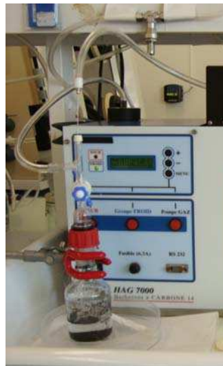
Figure 29 : Photos des connectiques utilisées entre le réacteur et le barboteur
