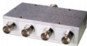
FIGURE 3.20 – Séparateur inductif testé pour Nucifer [90].
