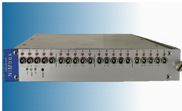
FIGURE 3.25 – Module logique programmable NIMbox de Wiener. Chaque connecteur peut être au choix une entrée ou une sortie [88].
