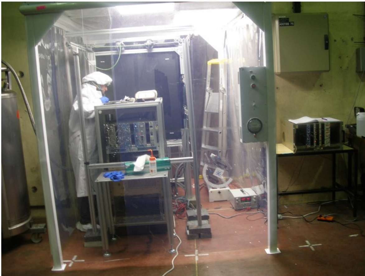
FIGURE C.1 – Le HPGe installé dans son blindage sous la tente propre. L'électronique visible au premier plan est celle du veto muon. Les mesures de propreté avec charlotte et blouse ont été abandonnées par la suite.
