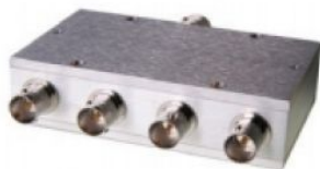
FIGURE 3.20 – Séparateur inductif testé pour Nucifer [90].
