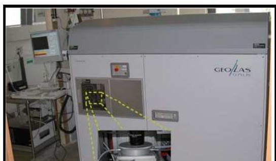
Figure 1 : Plate-forme automatisée Géolas CQ + . En encadré figure une vue en détail de la cellule d’ablation dans laquelle est disposé l’échantillon, derrière un hublot étanche aux émissions produites par le laser. Les paramètres d’ablation sont contrôlés par une station informatique (à gauche de l’appareil).
