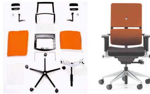
Figure 13 : Steelcase propose une chaise de bureau entièrement et facilement démontable pour changer les pièces cassées ou usées pendant la phase d'utilisation, et permettre une meilleure recyclabilité du produit en fin de vie
