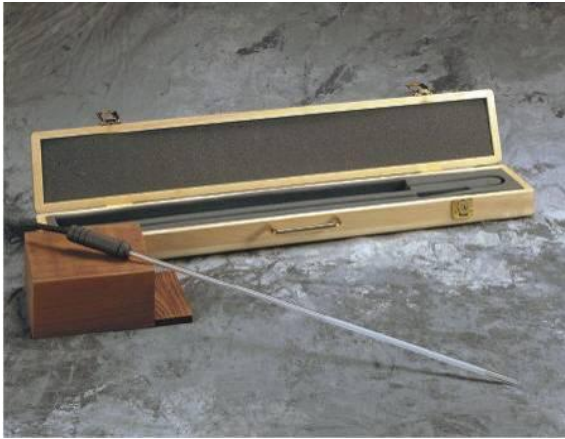
a-thermomètre à longue tige 25,5 Ω
