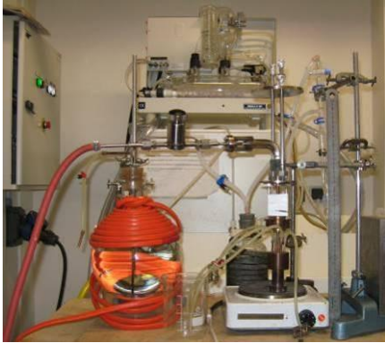
Figure 59 Photo du système de remplissage
