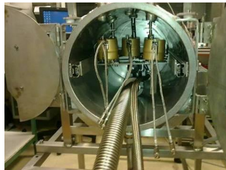
Figure 39 Photo de l'intérieur du système de thermalisation
