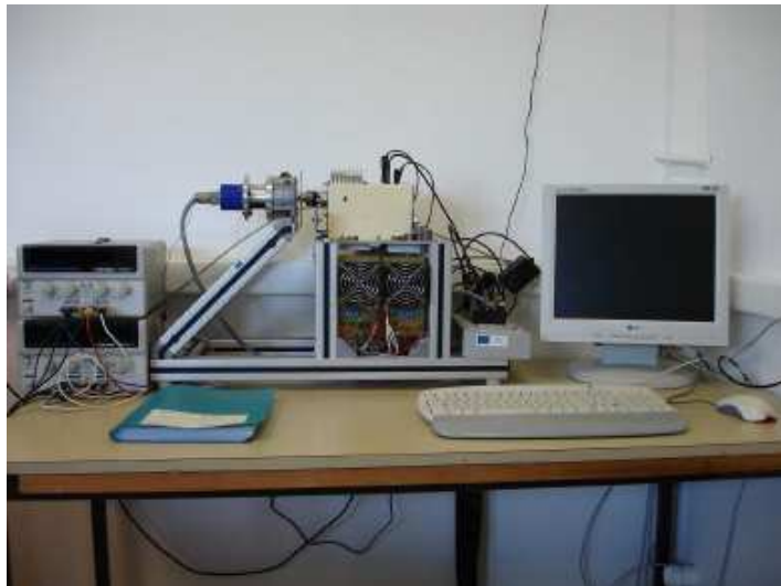
FIGURE 2.4 – Banc d'essai du moteur pas-à-pas.
