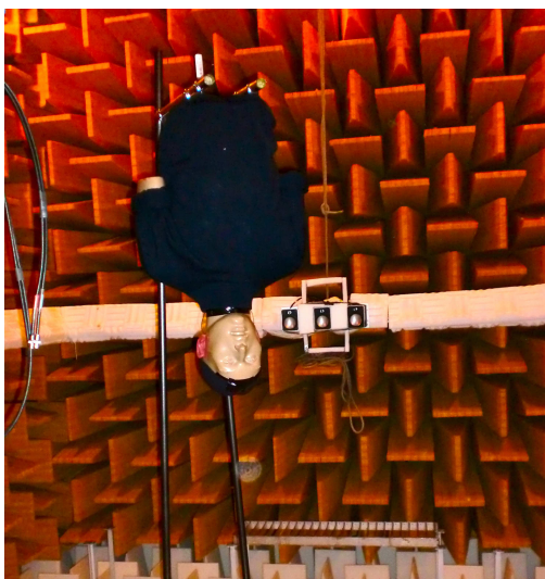
FIGURE 2.5 – Photo du système de mesure d’HRTF de la chambre anéchoïque de l’IRCAM avec le mannequin KEMAR (positionné à l’envers) attendant patiemment que l’on mesure les HRTF de son hémisphère bas.
