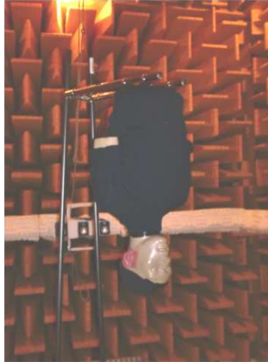
FIGURE 4.12 – Photo de l’installation du mannequin KEMAR à l’envers dans la chambre anéchoïque de l’IRCAM pour réaliser la mesure des HRTF comprises entre 0 et -90^\circ d’élévation.
