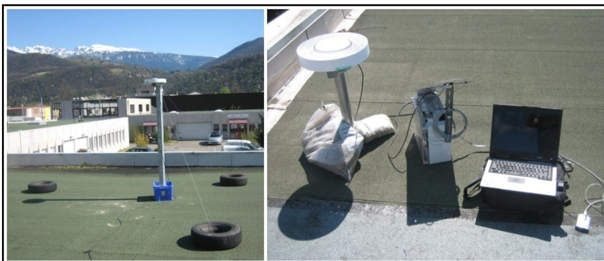
Figure 19 : Instrumentation GPS : Station de référence sur le toit de Myotis (gauche) et station mobile sur le toit du LGIT (droite)
