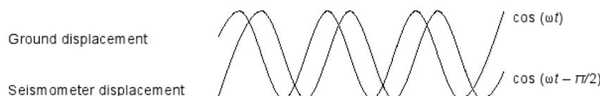
Figure B.1.1 : Déphasage entre déplacement du sol et déplacement de la masse (d'après NMSOP)
