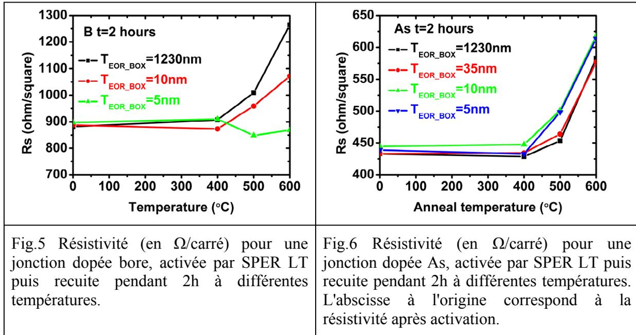
Dans tous les cas, tant pour le bore que pour l'arsenic, on observe que la résistance de couche mesurée pour des jonctions source/drain FD-SOI activées par SPER LT est similaire à celle obtenue par activation HT, aussi bien au début, juste après le recuit d'activation, qu'après des recuits post-activation à différentes températures entre 400°C et 600°C. En conséquence, la SPER LT semble convenir pour la fabrication des transistors FDSOI des couches inférieure et supérieure.
