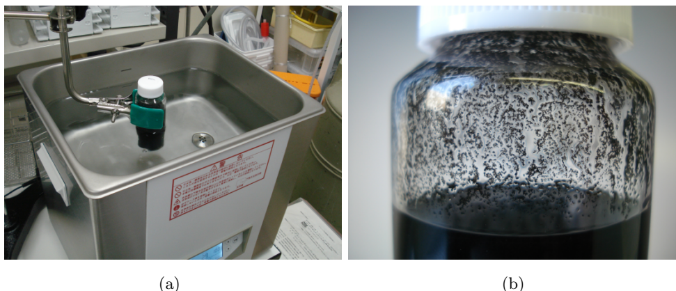
Fig. 1.6 – (a) Sonication des tubes dans le méthanol – (b) La suspension de tubes après sonication ne doit pas présenter d'agrégats attachés sur les parois du flacon.
