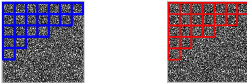
Fig 5.3 – Fenêtres d'interrogation. A gauche, image à l'instant  $t$ , à droite à l'instant  $t + \Delta t$ .
