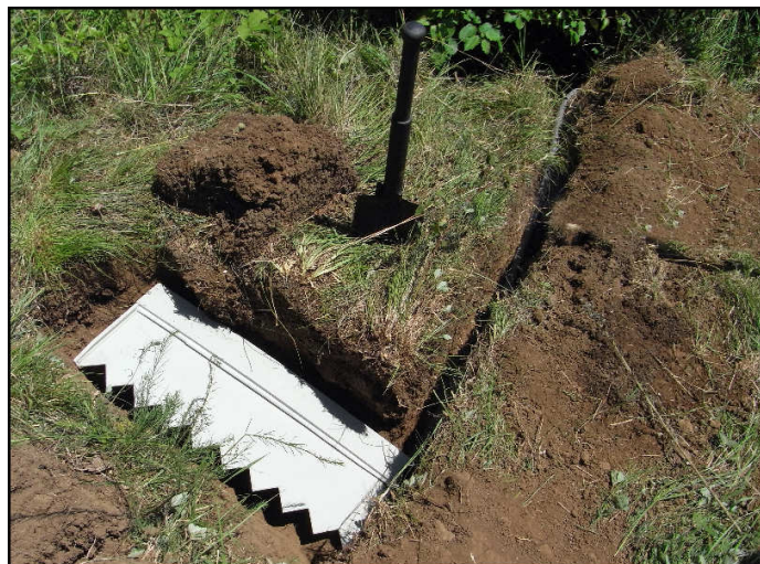
Figure 2.5 : Photo de l'installation d'une plaque lysimétrique.
