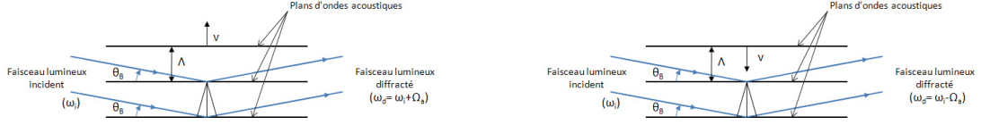
FIGURE 4.8 – Interaction de Bragg entre un faisceau lumineux incident et un faisceau acoustique. A gauche : procédé anti-Stokes. A droite : procédé Stokes.
