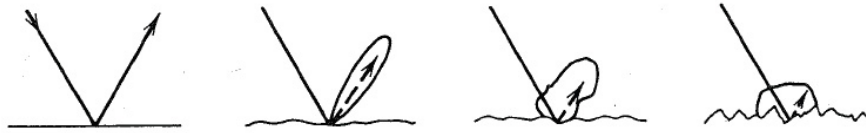
FIGURE 2.2 – Schéma extrait de Elachi (2006) montrant la transition du cas spéculaire (à gauche) au cas lambertien (à droite) lorsque la rugosité de surface augmente.
