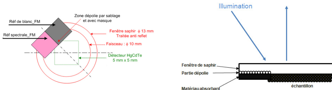
FIGURE 9.27 – Schémas illustrant le concept de la cible d'étalonnage de vol. A gauche : vue de dessus. A droite : vue de côté.
