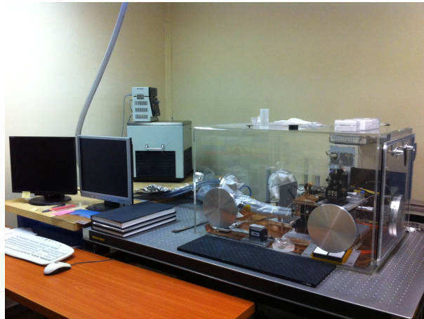
FIGURE 5.5 – Vue de la salle où se trouve le breadboard, avec le système de pilotage, l'enceinte purgée à l'azote sec et le système de refroidissement LAUDA.
