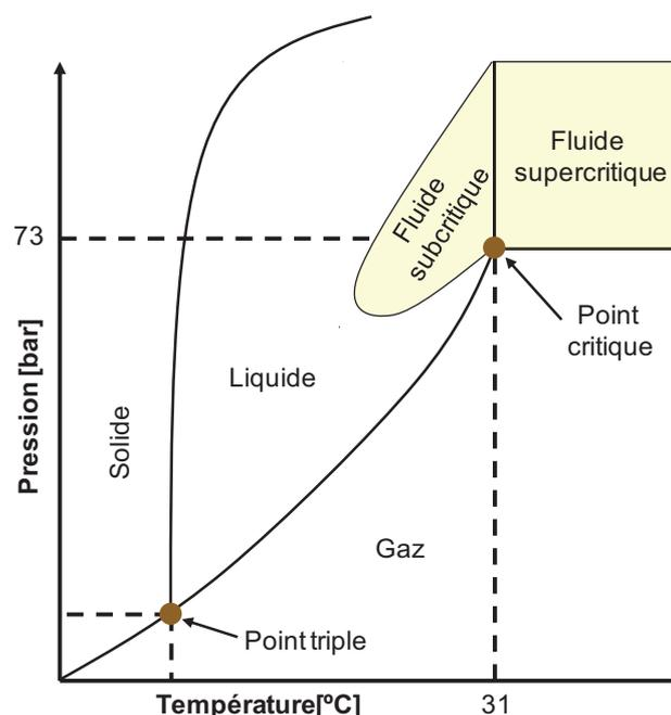
**Figure II.25. Diagramme de phase de CO<sub>2</sub> (adapté de [106])**
