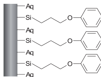
Figure III.35. Représentation schématique de la phase stationnaire Synergi Polar RP [71]
