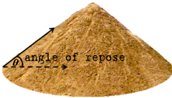
Figure 6. Tas de sable indiquant l'angle de repos.
