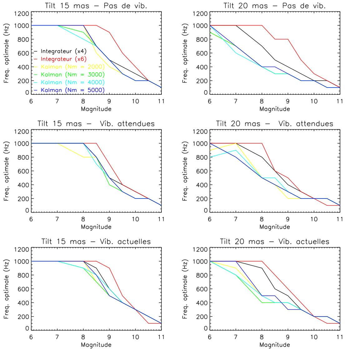
**Figure 4.4** – Fréquence de boucle optimale en fonction de la magnitude de l'étoile obtenue pour chaque contrôleur, avec les mêmes conditions d'observation que pour les figures 4.2 et 4.3. Le palier à 1 kHz est une limite des simulations, la plage des fréquences simulées s'étendant entre 100 et 1000 Hz.
