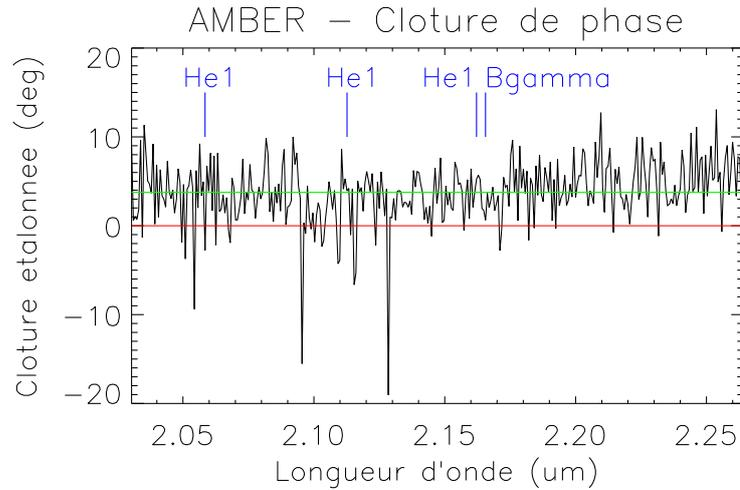
**Figure 6.7** – Clôture de phase de Vela X-1 étalonnée par HD 76 304, en fonction de la longueur d'onde. Les positions spectrales des quatre raies détectées dans le spectre sont représentées par des tirets bleus verticaux.
