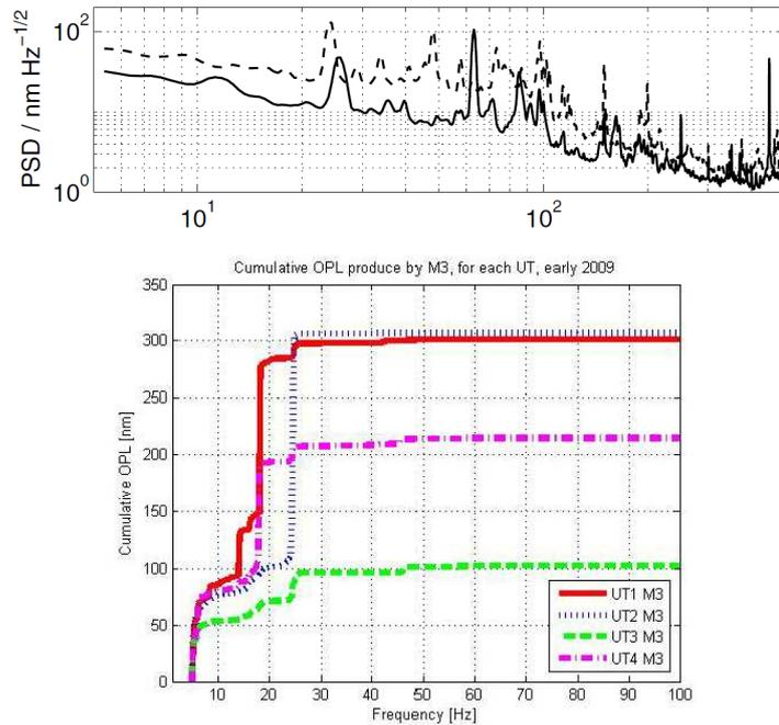
**Figure 2.8** – **Haut** : en pointillés, spectre des résidus de différence de marche mesuré avec le suiveur de franges de PRIMA sur les UTs (et sur les ATs en traits pleins). Extrait de [Sahlmann et al. \(2009\)](#). **Bas** : écart-type cumulé des vibrations en fonction de la fréquence, mesuré en 2009 sur le miroir M3 de chaque télescope. Extrait de [Poupar et al. \(2010\)](#)
