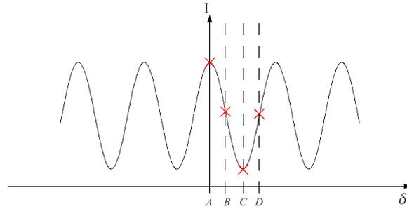
**Figure 3.4** – Principe de la modulation de type ABCD : l'intensité des franges est échantillonnée sur quatre points en quadrature de phase. Si la différence de marche est nulle comme sur cet exemple, *A* correspond à une frange brillante, *C* à une frange sombre, et *B* et *D* sont aux maxima de la dérivée de la fonction cosinus, points les plus sensibles aux variations de différence de marche.
