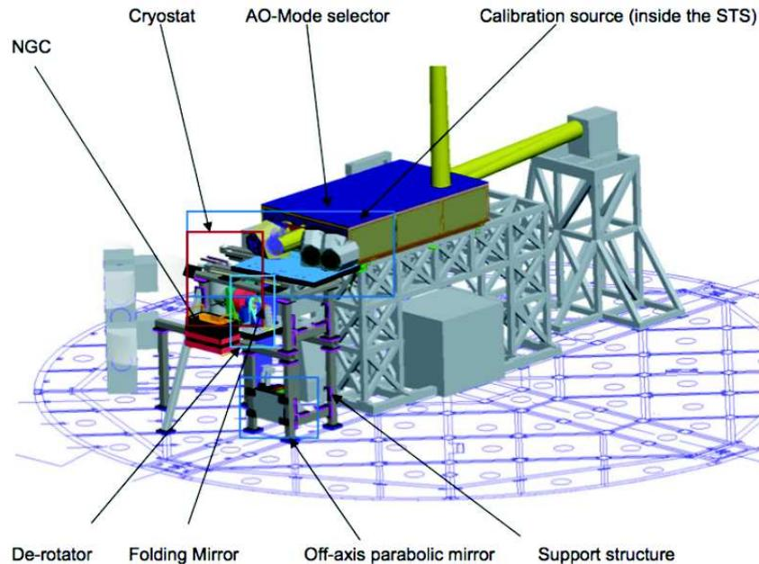
**Figure 1.11** – Schéma du sensor de front d’onde infrarouge, montrant les faisceaux issus des télescopes (en jaune), et le séparateur de faisceaux (STS) à l’interface avec le sensor de front d’onde. Tiré de [Kendrew et al. \(2012\)](#).
