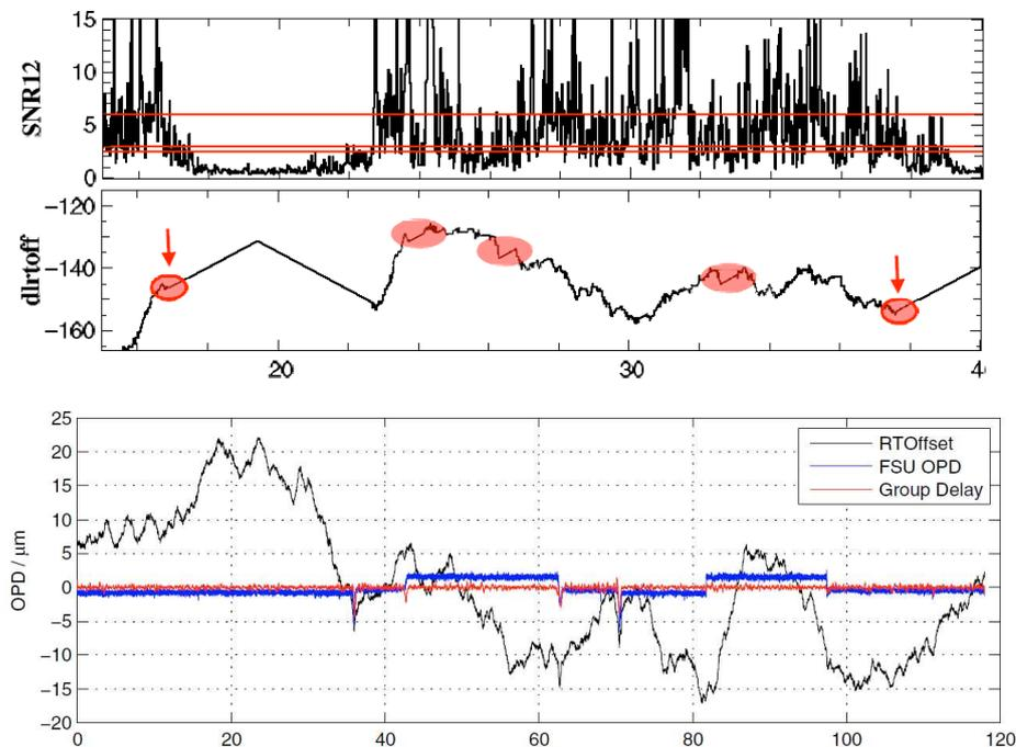
**Figure 2.3** – **Haut** : séquence temporelle de fluctuation de différence de marche mesurée par FINITO, et mesure de rapport signal-sur-bruit correspondante; tiré de [Le Bouquin et al. \(2008\)](#); abscisses en secondes, ordonnées en microns. **Bas** : de même avec le suiveur de franges de PRIMA; tiré de [Sahlmann et al. \(2009\)](#); abscisses en secondes.
