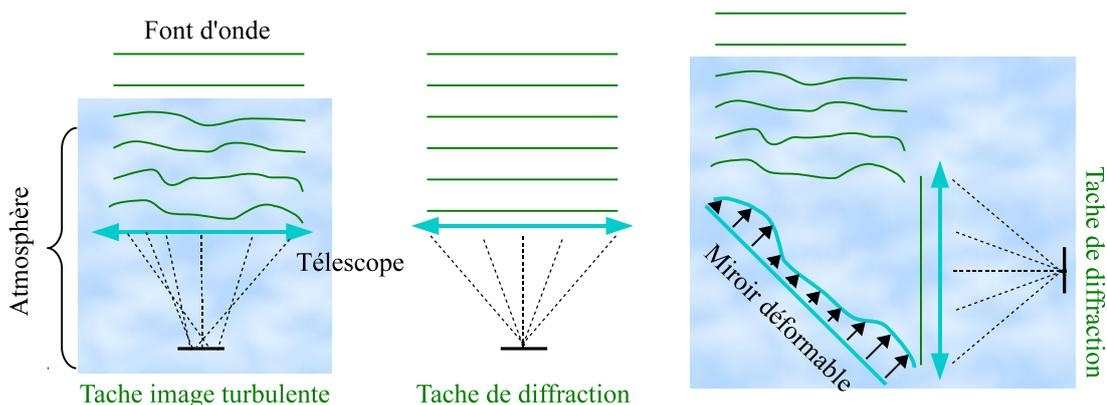
**Figure 1.3** – **Gauche** : illustration de la perturbation du front d'onde d'un objet à l'infini par traversée de l'atmosphère. **Milieu** : imagerie dans l'espace, non perturbée par l'atmosphère. **Droite** : restauration de la résolution d'un instrument par optique adaptative et correction du front d'onde par un miroir déformable.
