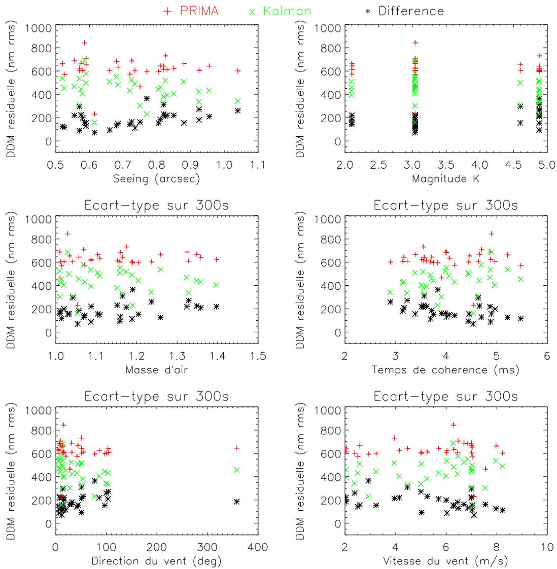
**Figure 4.14** – Écart-types des résidus en fonction des conditions d'observation, mesurés avec le suiveur de franges de PRIMA (rouge), simulés avec un contrôleur Kalman ( $N_m = 5000$ ) (vert), et différence entre ces deux valeurs (noir). Calcul sur  $\sim 300$  s.
