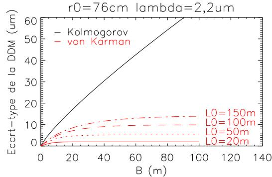
**Figure 2.4** – Écart-type des fluctuations de différence de marche en fonction de la longueur de base pour un spectre de Kolmogorov, et un spectre de von Kármán avec différentes valeurs de  $L_0$ .
