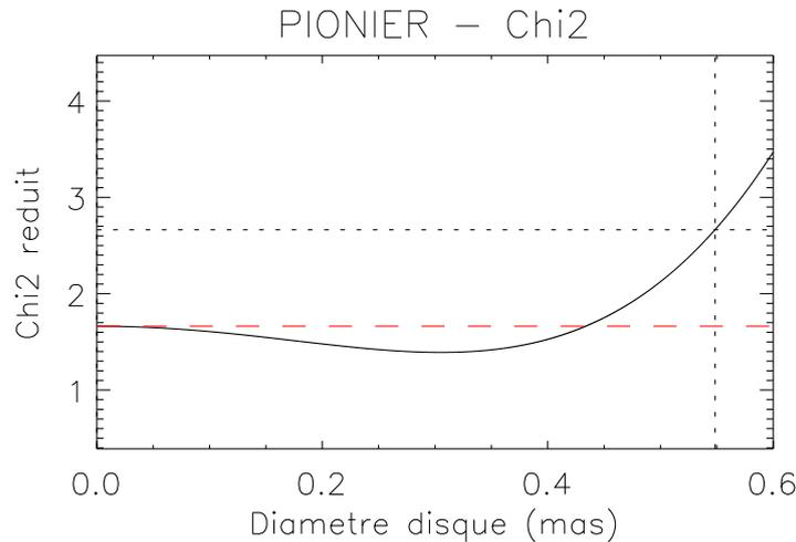
**Figure 6.14** –  $\chi^2$  réduit obtenu en comparant les visibilité carrées mesurées au modèle d’un disque uniforme, en fonction du diamètre angulaire du disque. Les tirets rouges représentent la valeur du  $\chi^2$  réduit obtenu pour une étoile ponctuelle (diamètre nul). Les traits pointillés noirs bornent une variation de 1 du  $\chi^2$  réduit par rapport à cette valeur, et indiquent le diamètre du modèle correspondant à cette variation significative du  $\chi^2$ .
