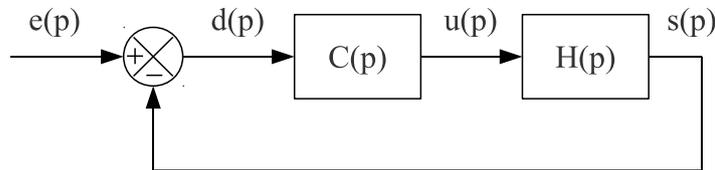
**Figure 3.11** – Schéma d'asservissement de la boucle de contrôle.  $C$  est la fonction de transfert du contrôleur,  $H$  celle du système,  $e$  est la consigne à laquelle on souhaite asservir le système,  $s$  est la mesure,  $d$  est l'erreur à la consigne, et  $u$  la commande appliquée aux actionneurs. Les grandeurs sont exprimées dans le domaine de Laplace, et  $p$  est la variable de Laplace.
