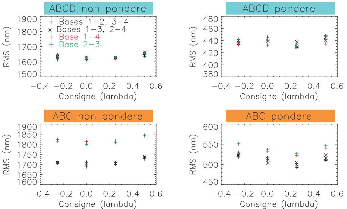
**Figure 4.24** – Écart-type des résidus de différence de marche de chaque base, en fonction de la consigne  $\Lambda_c$ , pour une étoile de magnitude  $K = 10$ , avec 150 nm rms de vibrations, 10  $\mu\text{m}$  de turbulence atmosphérique, et 15 mas de tip-tilt résiduel.
