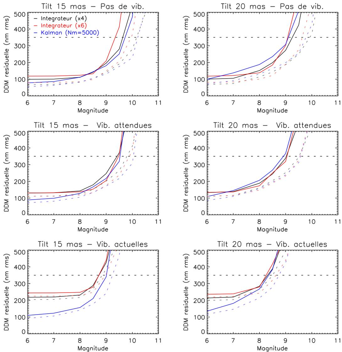
**Figure 4.7** – Gros plan de la figure 4.6, présentant les différences de marche résiduelles obtenues avec les intégrateurs et le contrôleur Kalman basé sur un modèle de perturbations à 5000 points. Les courbes en pointillés rappellent les différences de marche résiduelles obtenues pour 10 μm rms de perturbation atmosphérique présentées à la figure 4.3.
