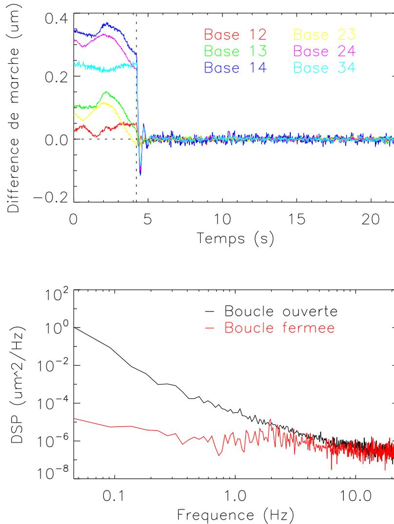
**Figure 5.9** – **Haut** : fermeture de la boucle de contrôle avec le démonstrateur du suiveur de franges. Différences de marche estimées sur les six bases avant et après enclenchement de l’asservissement (à  $t = 4,2$  s). **Bas** : spectres des résidus de différence de marche, moyennés sur les six bases, mesurés en boucle ouverte et en boucle fermée.
