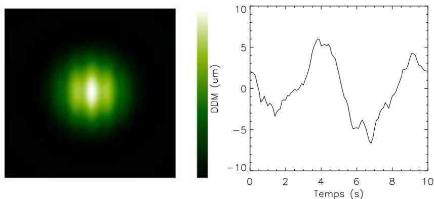
**Figure 1.13** – **Gauche** : simulation de franges d'interférences obtenues sur une étoile non résolue, intégrée pendant 10 s pendant lesquelles la différence de marche entre les télescopes varie à cause de la turbulence atmosphérique. **Droite** : variation de la différence de marche simulée.
