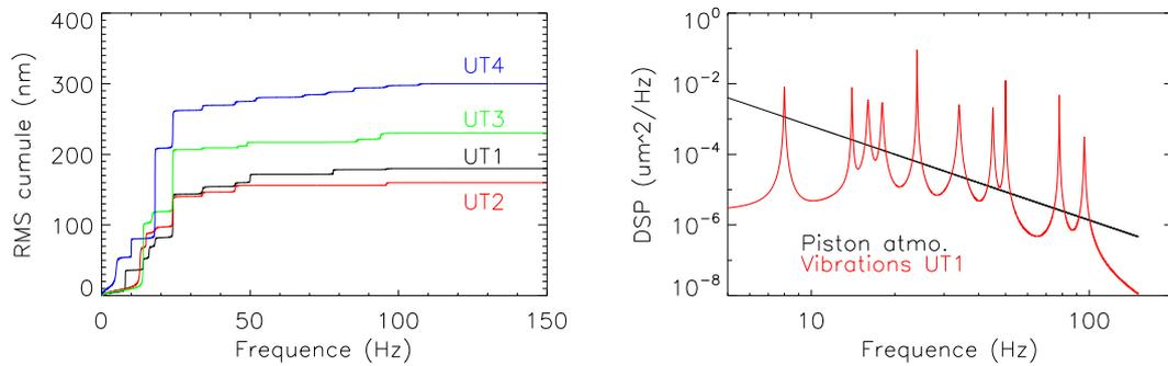
**Figure 2.7** – **Gauche** : écart-type cumulé des vibrations en fonction de la fréquence, pour chaque télescope. **Droite** : spectre du piston atmosphérique et des vibrations simulées pour le télescope UT1 (spectre de von Kármán,  $L_0 = 100$  m, écart-type de  $10/\sqrt{2}$   $\mu\text{m}$ ).
