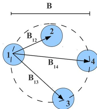
**Figure 1.4** – Exemple de synthèse de quatre ouvertures : au lieu d'utiliser une pupille pleine de diamètre  $B$ , on l'échantillonne par quelques pupilles de diamètre  $D$  plus petit, positionnées avec un espacement maximal égal à  $B$ .
