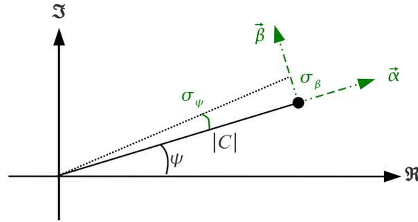
**Figure 3.10** – Estimation de la précision sur la mesure de la phase d'un vecteur complexe : connaissant la dispersion  $\sigma_\beta$  du vecteur sur l'axe  $\beta$  (grâce à la matrice de covariance dans le repère complexe et à la matrice de changement de repère) et sa norme  $|C|$ , on en déduit la précision de mesure sur la phase du vecteur :  $\sigma_\psi = \arctan \frac{\sigma_\beta}{|C|}$ .
