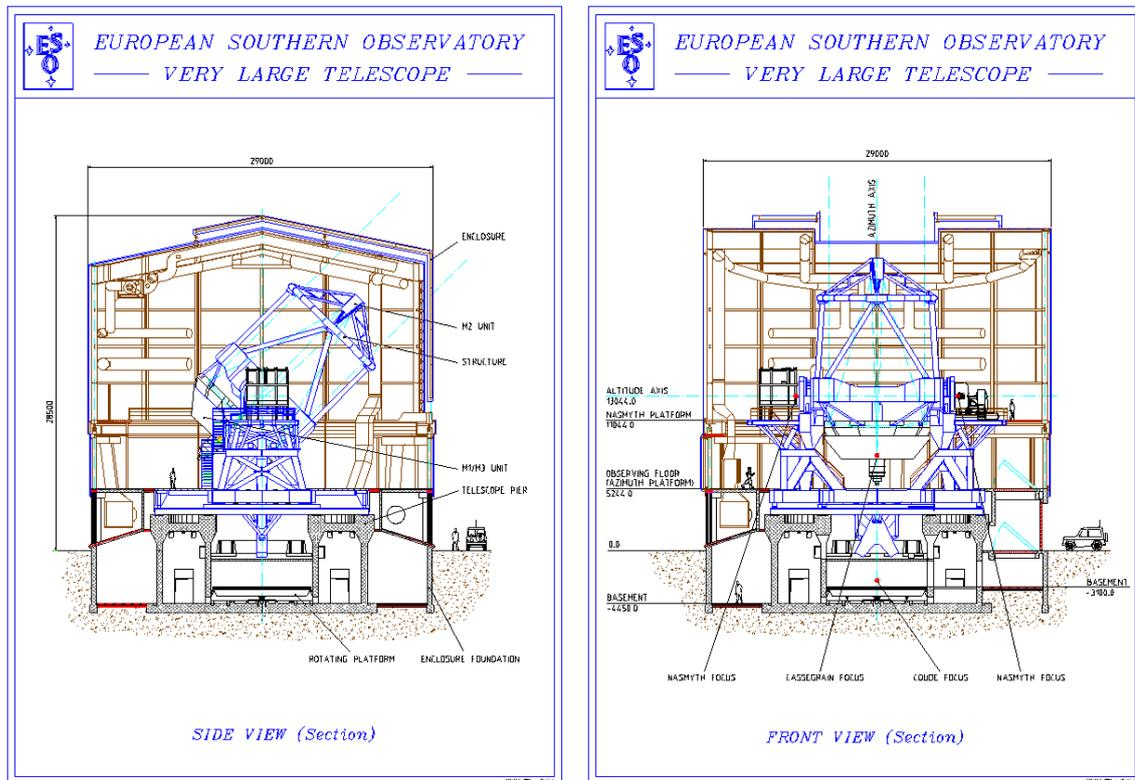
**Figure 2.5** – Vue schématique d'un UT de profil et de face.
