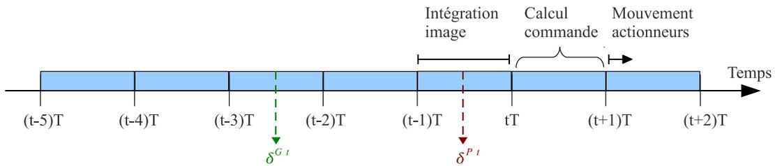
**Figure 3.12** – Diagramme de temps du suiveur de franges : la commande appliquée aux actionneurs à l'itération  $t + 1$  résulte d'une seule image pour l'estimateur de retard de phase, et de la moyenne de cinq images pour l'estimateur de retard de groupe. Dans le premier cas, l'effet de moyenne pendant le temps d'intégration  $T$  donne une estimation de la différence de marche à l'instant  $(t - 0,5)T$ , et dans le second cas, à l'instant  $(t - 2,5)T$ .
