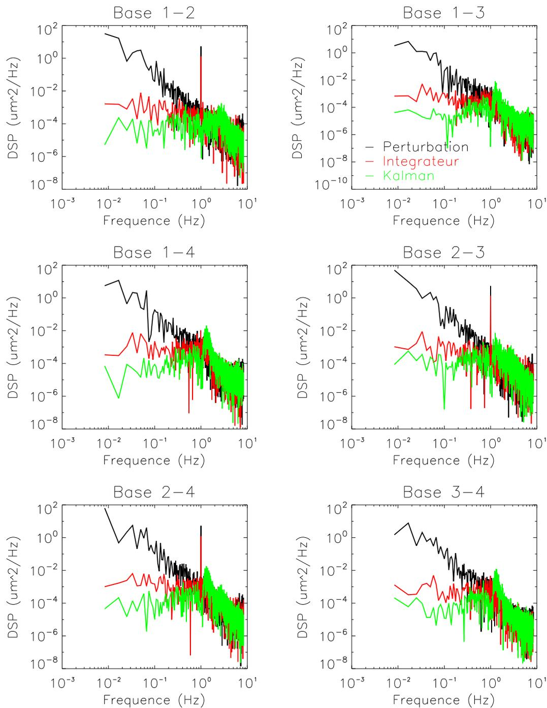
**Figure 5.10** – Densités spectrales de puissances mesurées sur les six bases du démonstrateur, en boucle ouverte (noir), avec un intégrateur (rouge), et un contrôleur Kalman (vert). Une vibration à 1 Hz est artificiellement ajoutée par l'actionneur en piston du télescope 2.
