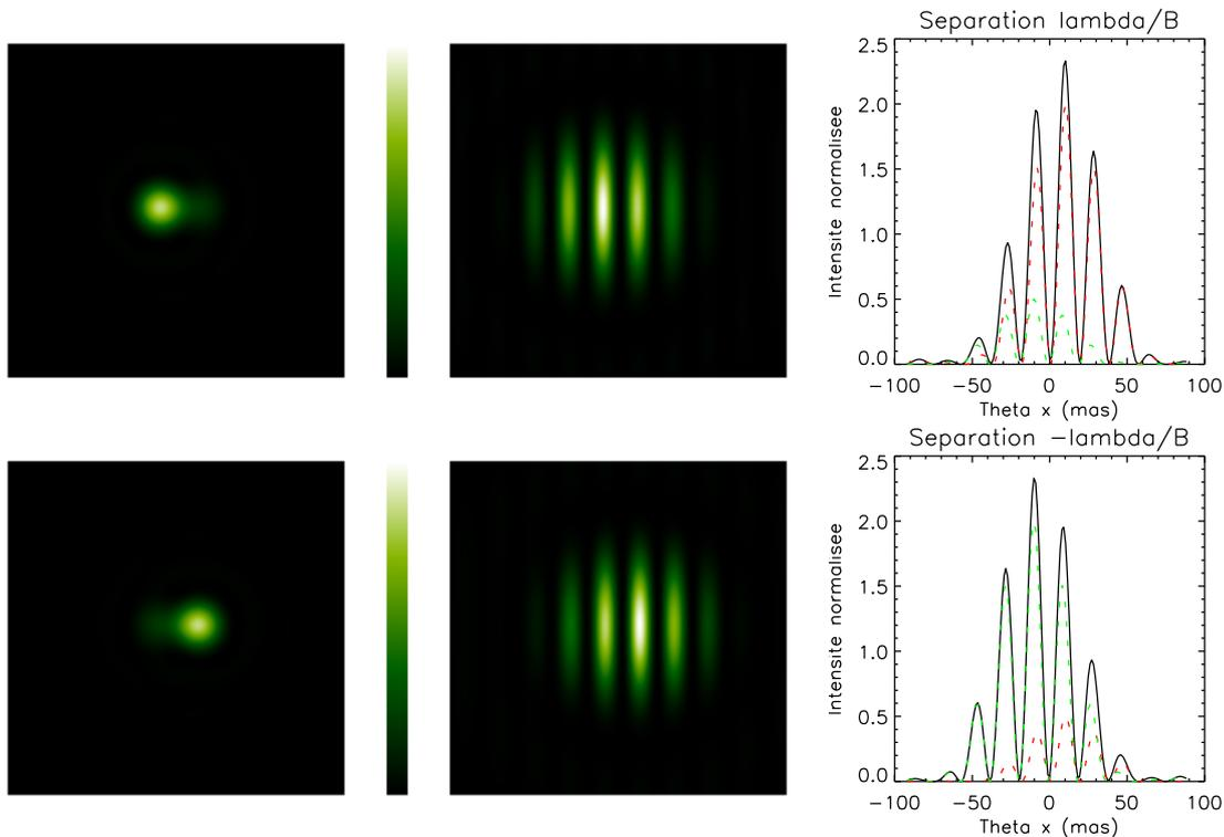
**Figure 1.7** – Images de deux binaires à la limite de résolution d'un interféromètre à deux télescopes ( $D = 8$  m,  $B = 25$  m,  $\lambda = 2,2 \mu\text{m}$ ), pour deux rapports de flux différents. *Gauche* : image résolue de la binaire (téléscope de diamètre  $B$ ). *Milieu* : image par l'interféromètre. *Gauche* : Coupe centrale. Illustre le fait que c'est la phase des interférences (position des franges) qui donne l'information sur la symétrie de l'objet et non le contraste des franges.
