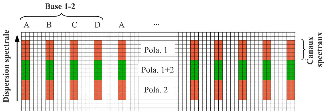
**Figure 3.5** – Structure d'une image du détecteur du suiveur de franges. L'image en rouge correspond à la configuration de l'instrument où les polarisations sont séparées, l'image en vert correspond à la configuration avec les deux polarisations superposées.
