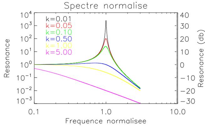
**Figure 2.6** – Illustration de la résonance d’une vibration en fonction de son coefficient d’amortissement  $k$ . Densité spectrale de puissance décrite par l’équation 2.39, normalisée par sa valeur à la fréquence nulle, et fréquence normalisée par la fréquence propre de la vibration.
