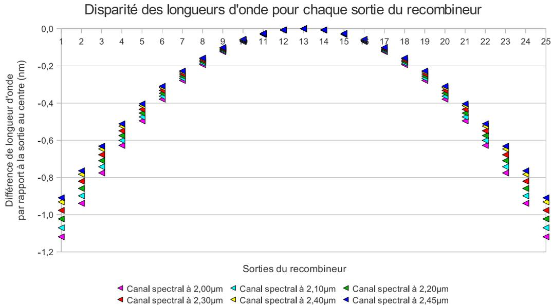
**Figure 5.7** – Disparité des longueurs d’onde attendue pour GRAVITY : écart en longueur d’onde par rapport à la voie centrale du recombineur, pour chaque canal spectral. L’écart maximal est inférieur à 1,2 nm. Données transmises par Christian Straubmeier.
