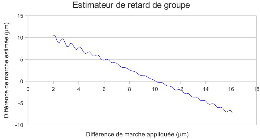
**Figure 5.5** – Illustration de la non-linéarité de l'estimateur de retard de groupe liée à des longueurs d'onde disparates sur une même base. Une rampe de différence de marche est appliquée par l'actionneur du télescope 3, le retard de groupe est estimé pour la base formée entre les télescopes 1 et 3.
