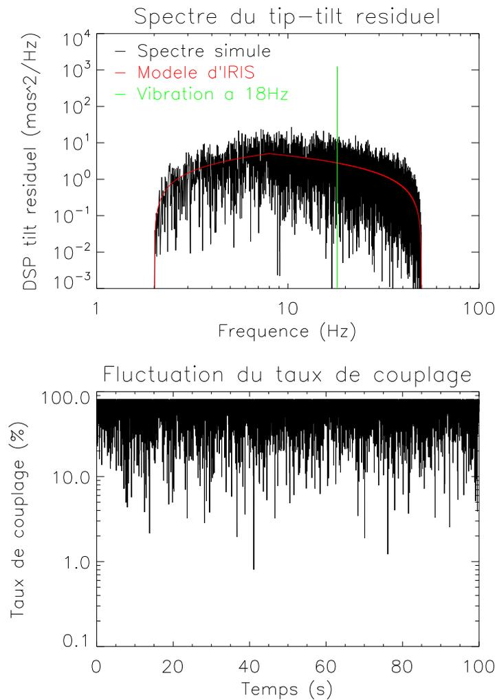
**Figure 2.12** – **Haut** : spectre du tip-tilt résiduel utilisé pour les simulations de ce manuscrit ; modèle de la fonction de transfert d'IRIS en rouge, vibration additionnelle en vert, et exemple de spectre simulé en noir (à partir d'une séquence temporelle de bruit blanc). **Bas** : séquence temporelle de couplage dans une fibre, fluctuations correspondant au spectre simulé à gauche. L'injection maximale est de 81 %, l'injection moyenne est de 65 %.
