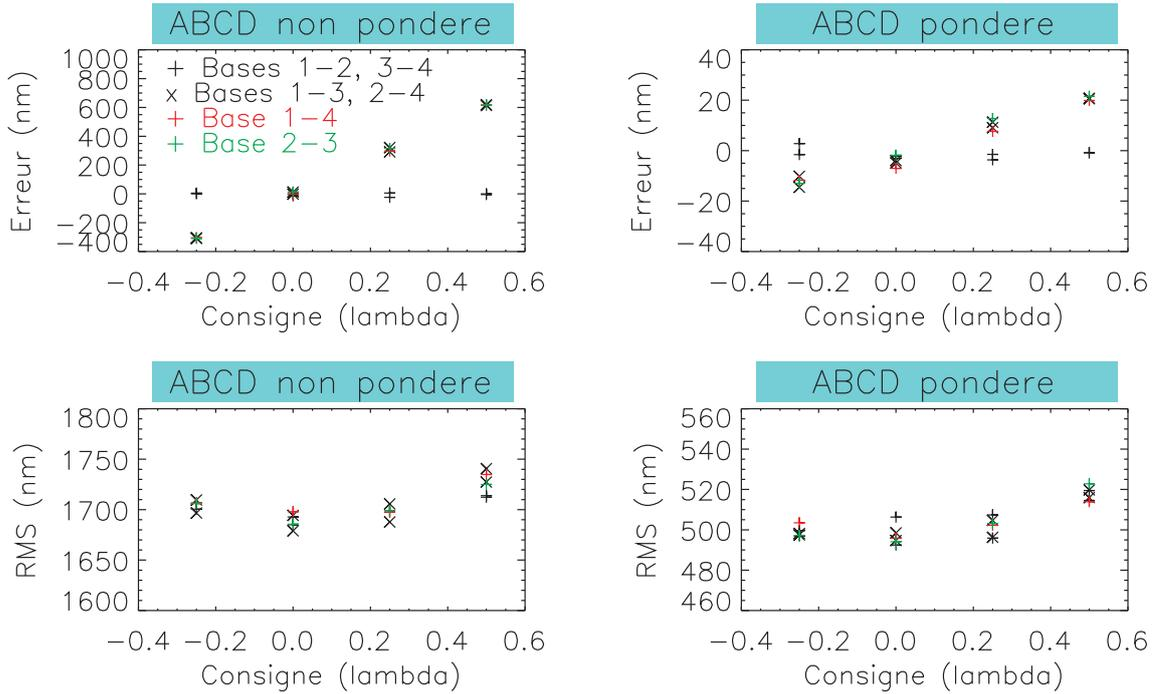
**Figure 4.25** – Erreur à la consigne (haut) et écart-type des résidus de différence de marche (bas) de chaque base, en fonction de la consigne  $\Lambda_c$ , pour une étoile de magnitude  $K = 10, 1$ , avec 150 rms de vibrations, 10  $\mu\text{m}$  de turbulence atmosphérique, et 15 mas de tip-tilt résiduel.
