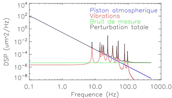
**Figure 3.14** – Spectre typique des perturbations : une composante large bande due au piston atmosphérique, des pics de vibration étroits et très localisés, et une queue plate à haute fréquence due au bruit de mesure blanc.
