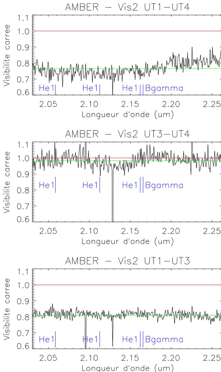
**Figure 6.8** – Visibilité carrée de Vela X-1, étalonnée par HD 76 304, mesurées sur les trois bases formées par les télescopes UT1, UT3 et UT4. Les positions des quatre raies détectées dans le spectre sont représentées par les traits bleus. Les lignes horizontales vertes représentent les visibilités carrées moyennes sur la bande spectrale 2,030–2,264  $\mu\text{m}$ .
