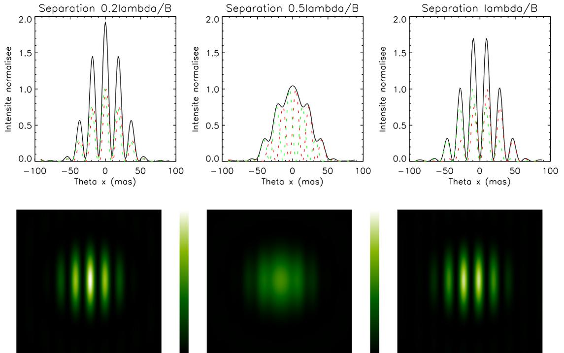
**Figure 1.6** – Franges d’interférence simulée, pour des binaires de différente séparation, obtenues avec un interféromètre à deux télescopes ( $D = 8$  m,  $B = 25$  m,  $\lambda = 2,2 \mu\text{m}$ ). La séparation de la binaire est respectivement  $0,2\lambda/B$ ,  $0,5\lambda/B$ , et  $\lambda/B$  (de gauche à droite). L’orientation de la binaire est alignée avec la base de l’interféromètre.
