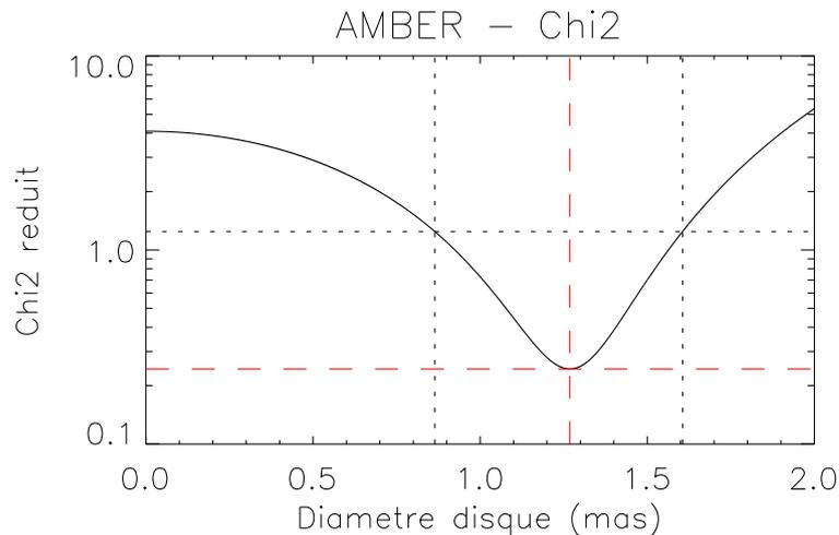
**Figure 6.10** –  $\chi^2$  réduit obtenu en comparant les visibilités carrées mesurées au modèle d'un disque uniforme, en fonction du diamètre angulaire du disque. Les tirets rouges indiquent le diamètre du meilleur modèle au sens des moindres carrés (1,27 mas) et le  $\chi^2$  réduit correspondant (0,24). Les traits pointillés noirs bornent une variation de 1 du  $\chi^2$  réduit par rapport à sa valeur minimale, et indiquent les variations correspondantes du diamètre du modèle.
