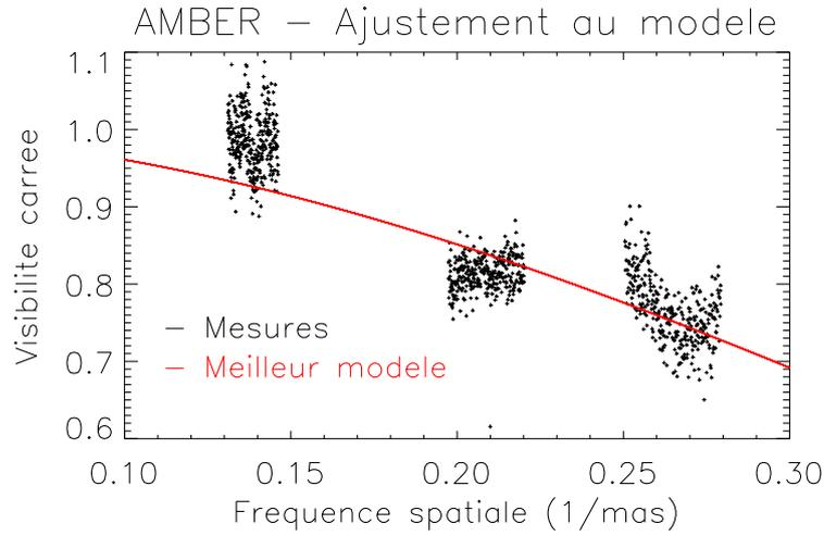
**Figure 6.9** – Visibilités carrées de Vela X-1 (noir), et visibilités carrées obtenues avec un modèle de disque uniforme de diamètre angulaire  $D_K = 1,27$  mas (rouge).
