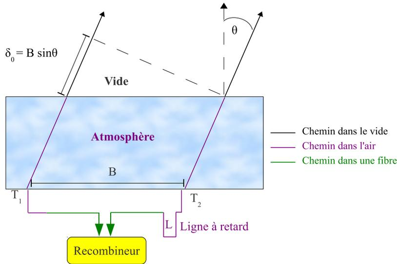
**Figure 3.8** – Illustration du phénomène de dispersion : la différence de marche  $\delta_0$  dans le vide liée à la direction de l'étoile est compensée par un chemin géométrique  $L$  par les lignes à retard dans l'air, dont l'indice varie avec la longueur d'onde (contrairement à l'indice du vide).
