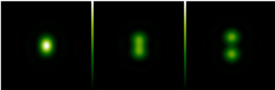
**Figure 1.1** – Illustration du pouvoir séparateur d'un instrument. Les images de deux objets ponctuels sont représentés. À gauche, les objets sont trop proches pour être résolus. Au milieu, la séparation entre les deux objets est à la limite de résolution de l'instrument. À droite, les deux objets sont suffisamment séparés pour être clairement discernables sur l'image.
