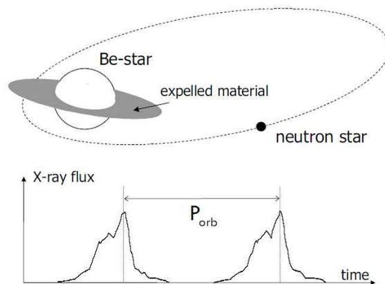
**Figure 6.1** – Principe de la binaire X à étoile Be. L'objet compact (ici une étoile à neutron) est sur une orbite excentrique autour de l'étoile Be qui ne remplit pas son lobe de Roche. Au passage au périastre, l'objet compact traverse le disque et accrète la matière éjectée par l'étoile Be à rotation rapide, provoquant ainsi une augmentation de la luminosité de l'objet compact dans le domaine des rayons X. Extrait de [Tauris & van den Heuvel \(2006\)](#).
