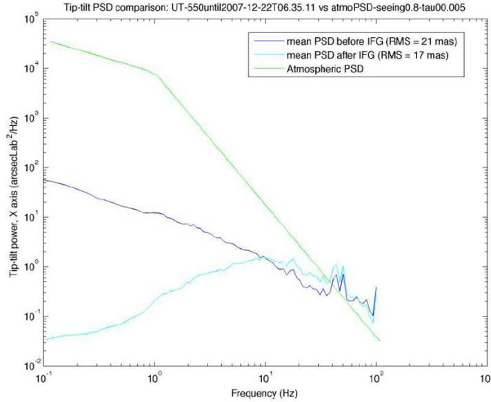
**Figure 2.11** – Spectre moyen du tip-tilt atmosphérique (en vert), des résidus après correction par l’optique adaptative MACAO et propagation dans les tunnels (en bleu foncé), et des résidus de tip-tilts après correction par MACAO et par le système de guidage IRIS (en bleu turquoise). Mesures sur ciel avec les UTs. Tiré de [Gitton & Haguenaer \(2008\)](#).
