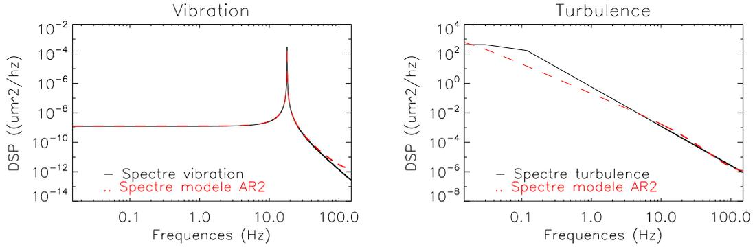
**Figure 3.13** – Spectres des perturbations (en noir) et spectre du modèle auto-régressif d'ordre deux correspondant (en rouge), pour une vibration à gauche, et la turbulence à droite (telle que caractérisée dans le chapitre 2).
