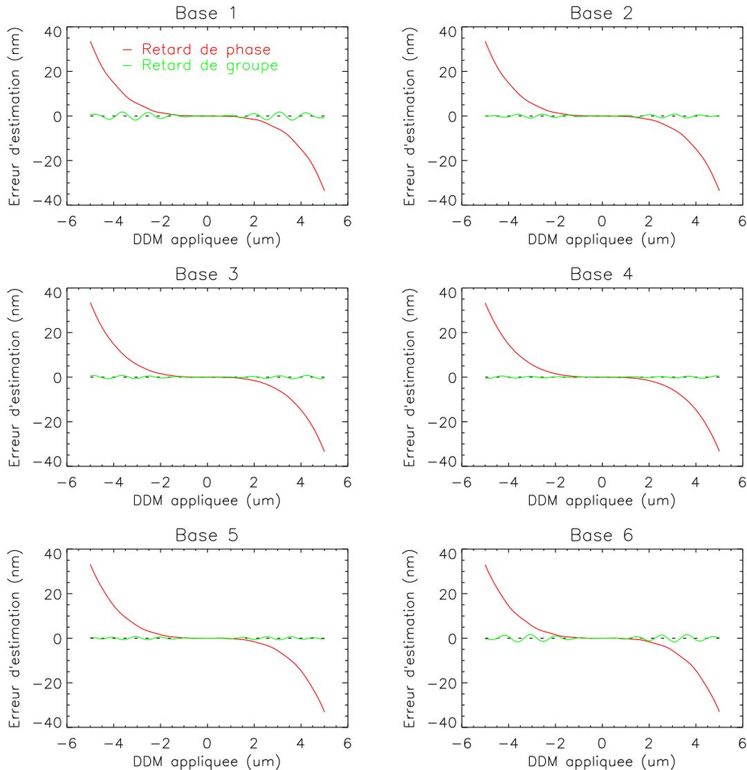
**Figure 5.8** – Erreurs attendues sur les estimateurs de différence de marche avec les longueurs d'onde attendues pour le spectromètre du suiveur de franges de GRAVITY, sur les six bases. Les bases 1 et 6 ont un biais légèrement supérieur aux autres bases car elles correspondent aux sorties extrêmes du recombineur, où les disparités en longueur d'onde sont les plus importantes.
