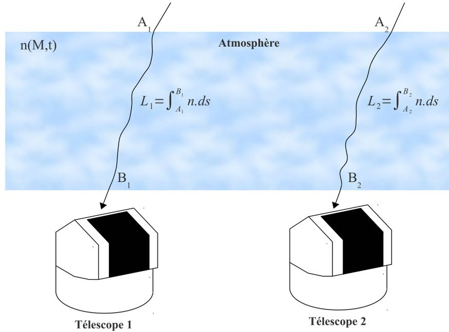
**Figure 2.1** – Illustration du principe de Fermat : un rayon lumineux se propage d'un point à un autre de façon à minimiser son trajet optique, et est donc dévié en fonction de l'indice local du milieu traversé. Ainsi, deux faisceaux traversant deux épaisseurs d'atmosphère turbulente différentes ne rencontrent pas exactement les mêmes indices et sont déviés différemment. De même, le chemin optique qu'ils ont traversé jusqu'au télescope est légèrement différent.
