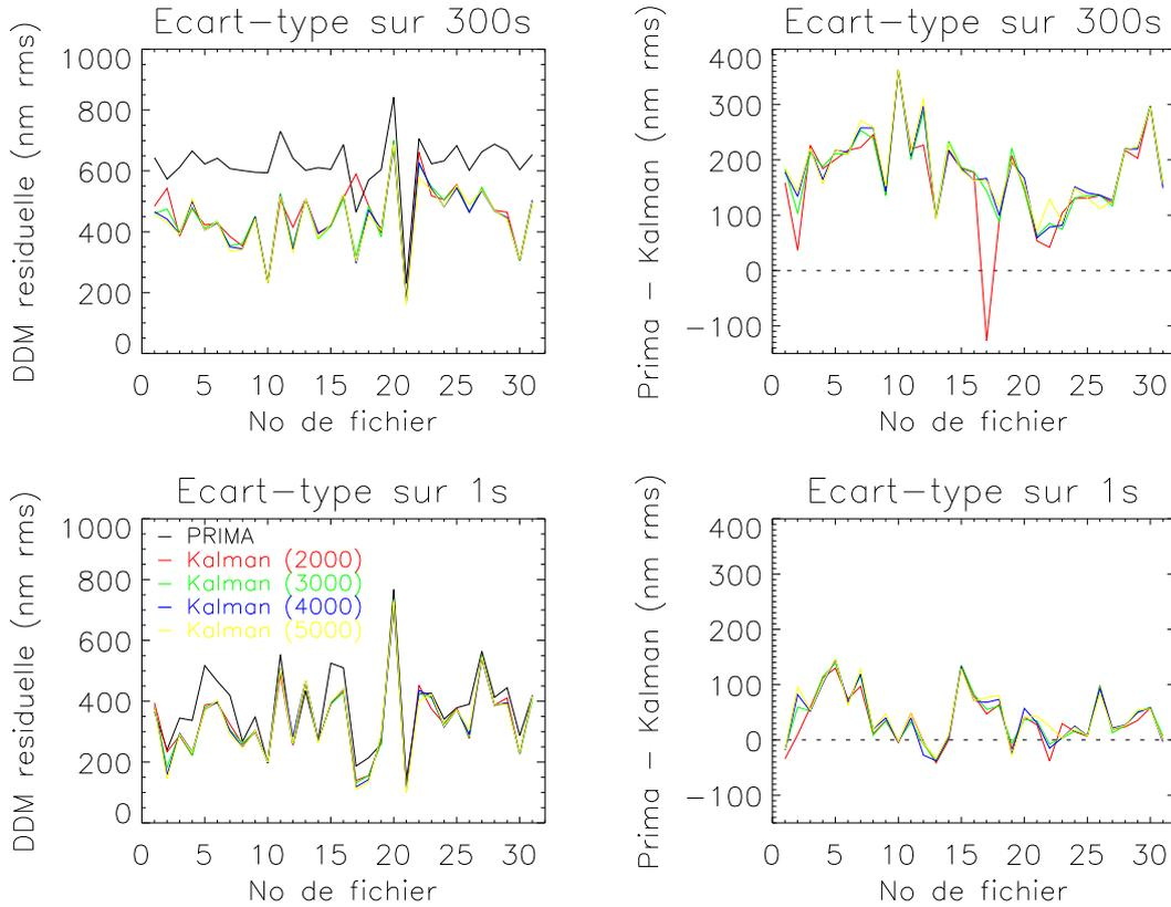
**Figure 4.13** – **Gauche** : écart-type des résidus de différence de marche mesurés avec le suiveur de franges de PRIMA et simulés avec le contrôleur Kalman utilisant des séquences de différentes longueurs pour calculer le modèle. Écart-type calculés sur 300 s en haut, et sur des fenêtres glissantes de 1 s en bas. **Droite** : différence entre les écarts-types mesurés par PRIMA et ceux simulés avec le contrôleur Kalman, calculés sur 300 s en haut, et sur des fenêtres glissantes de 1 s en bas.
