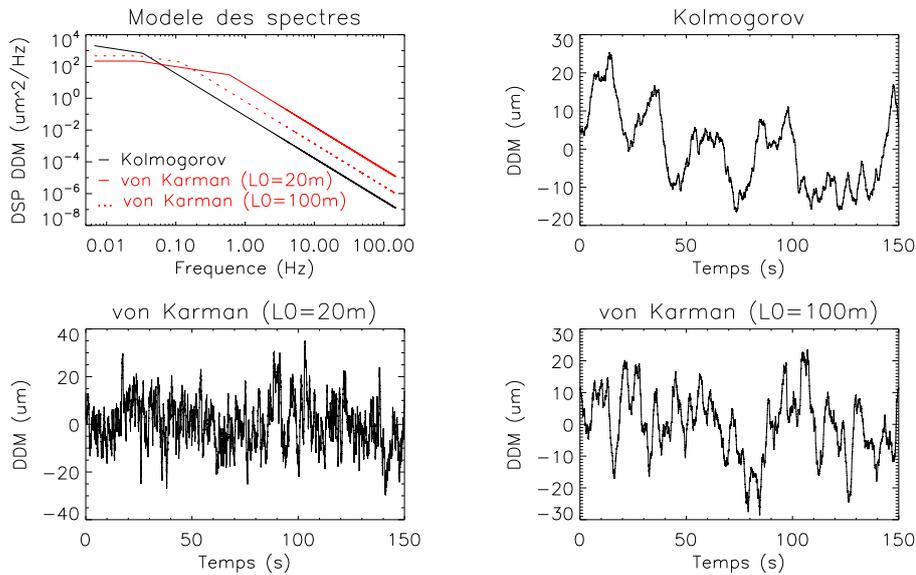
**Figure 2.2** – **Haut-gauche** : Modèles asymptotiques des spectres de la différence de marche, avec un modèle Kolmogorov et von Kármán avec deux valeurs différentes de  $L_0$  (20 et 100 m). Les trois spectres sont normalisés pour avoir la même énergie ( $\sigma_\delta = 10 \mu\text{m}$ ). **Autres** : simulation d'une séquence de perturbation pour ces trois spectres. Ces trois séquences temporelles ont le même écart-type, mais des composantes fréquentielles très différentes.
