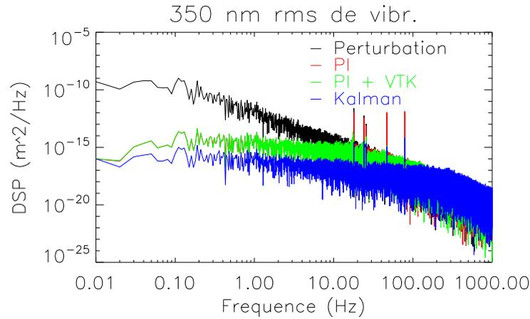
**Figure 4.12** – Densité spectrale de puissance de la perturbation (noir) et des résidus de différence de marche avec le contrôleur PI (rouge), PI associé au VTK (vert), et Kalman (bleu), pour un niveau total de 350 nm rms de vibrations, 12  $\mu\text{m}$  de turbulence, pour une étoile de magnitude six sans variation de flux.
