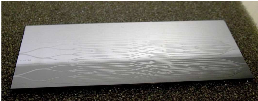
Figure 1.12 – Photographie d'un recombineur en optique intégrée tel que ceux qui seront utilisés dans GRAVITY pour recombinaison des faisceaux de l'étoile de référence et de l'objet étudié. Image fournie par Laurent Jocou.
