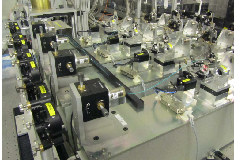
Figure 6.11 – Photographie de l'instrument PIONIER dans le laboratoire du VLTI, à la place qui sera occupée par GRAVITY d'ici deux ans. En avant-plan on voit l'un des modules d'injection dans une fibre, reproduit trois fois en arrière plan.
