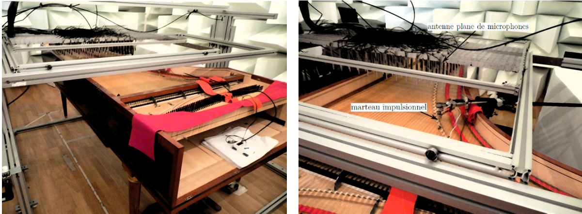
FIGURE 2.1 – Illustration du système d’holographie acoustique de champ proche pour la mesure de vibrations d’une table d’harmonie de piano forte. Photo prise à la Cité de la Musique de Paris
