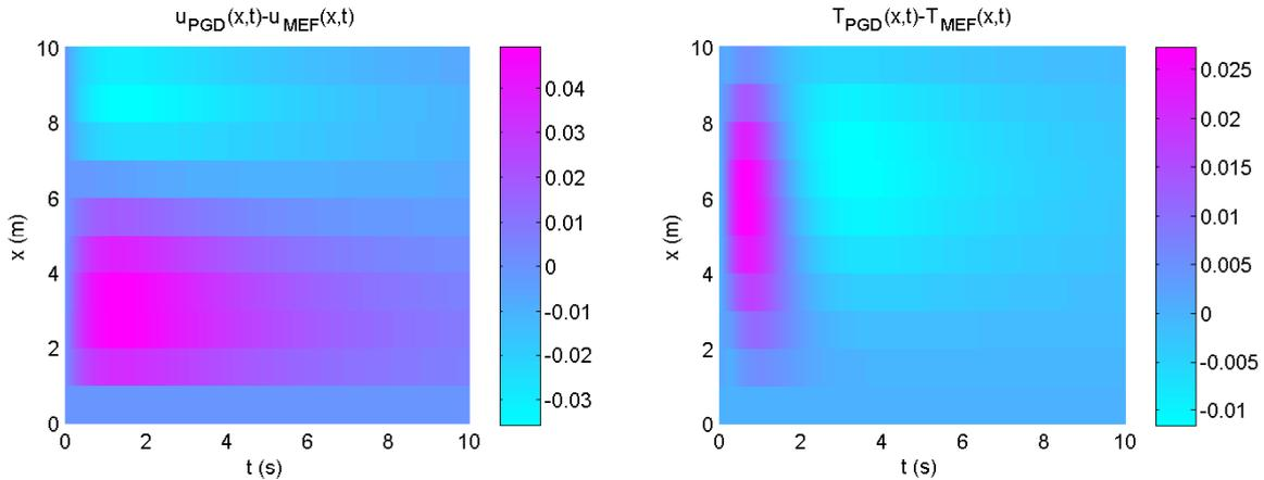
FIG. D.I-14 Carte d'écart en espace et en temps entre les solutions PGD et MEF du déplacement (à gauche) et de la température (à droite)
