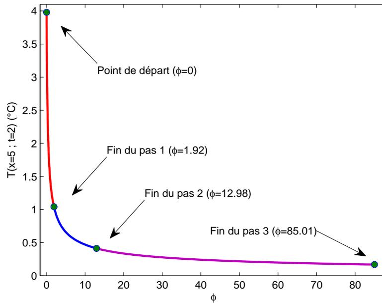
FIG. C.II-15 Evolution de la température au point  $(x = 5, t = 2)$  en fonction de  $\phi$  à l'ordre 15 de la MAN pour 3 pas de continuation déterminés par  $\delta = 10^{-4}$
