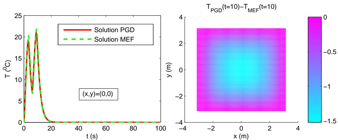
FIG. B.I-11 Evolution de la température en fonction du temps au point  $(x,y)=(0,0)$  pour la solution PGD et la solution MEF (gauche) et écart entre deux solutions à  $t=10$  en fonction de l'espace (droite)
