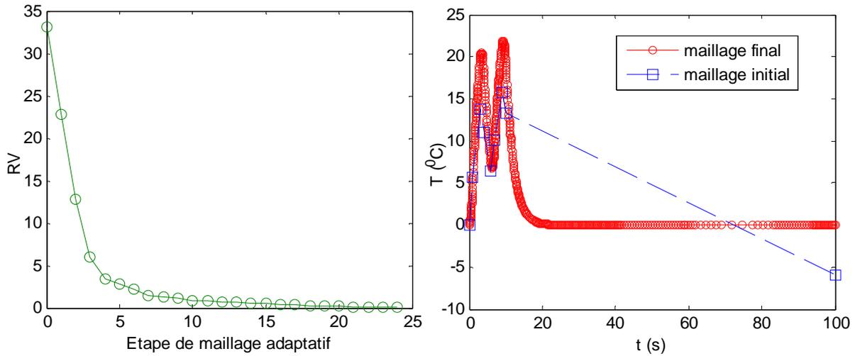
FIG. B.II-12 Evolution du résidu  $RV$  en fonction des étapes de maillage adaptatif (gauche) et évolution de la température au point  $(x,y)=(0,0)$  en fonction du temps (droite) dans le cas RPGD\_S22
