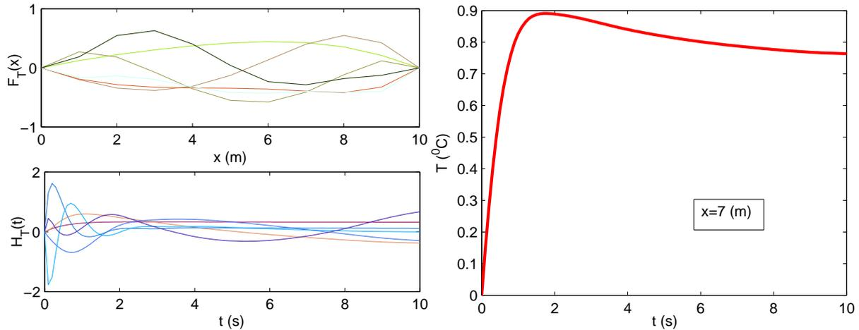
FIG. D.I-25 Maillage  $nt_u = 11, nt_T = 101$ - Interpolation cubique spline. Modes spatiaux et temporels pour la température (gauche). Evolution de la température en fonction du temps au point  $x=7$  (droite)
