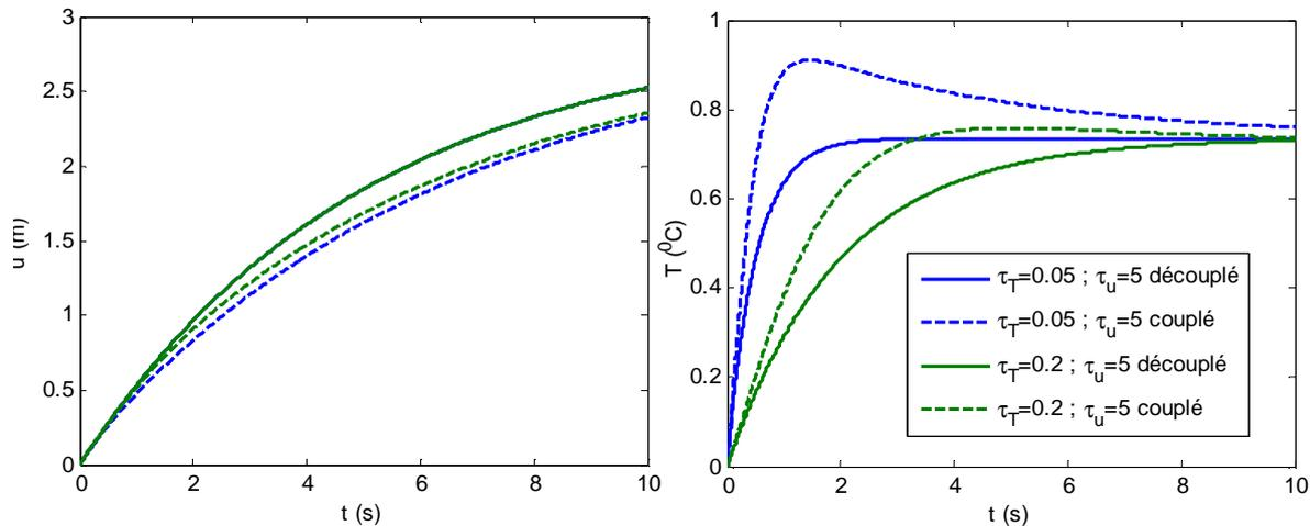
FIG. D.I-21 Cas couplé et découplé. Evolution du déplacement à  $x=5$  (à gauche) et de la température à  $x=7$  (à droite) pour différentes valeurs de  $\tau_T$  à  $\tau_u$  fixée
