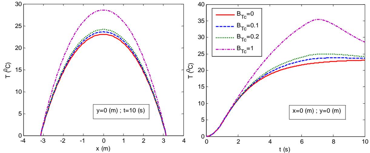
FIG. D.I-6 Evolution de la température suivant la direction  $x$  ( $y=0$ ,  $t=10$ ) et suivant le temps ( $x=0$ ,  $y=0$ ) pour différentes valeurs du coefficient  $B_{Tc}$
