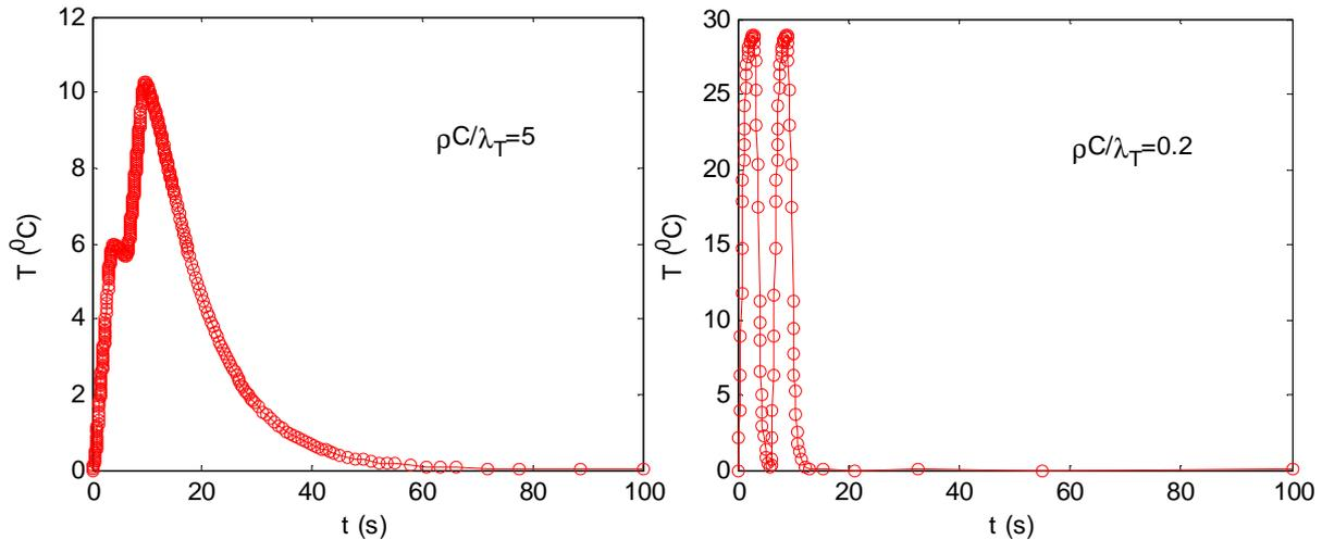
FIG. B.II-18 Evolution de la température au point  $(x,y)=(0,0)$  en fonction du temps. Cas (a)  $\rho C = 5$  ;  $\lambda_T = 1$  (gauche) et cas (b)  $\rho C = 0,2$  ;  $\lambda_T = 1$  (droite)
