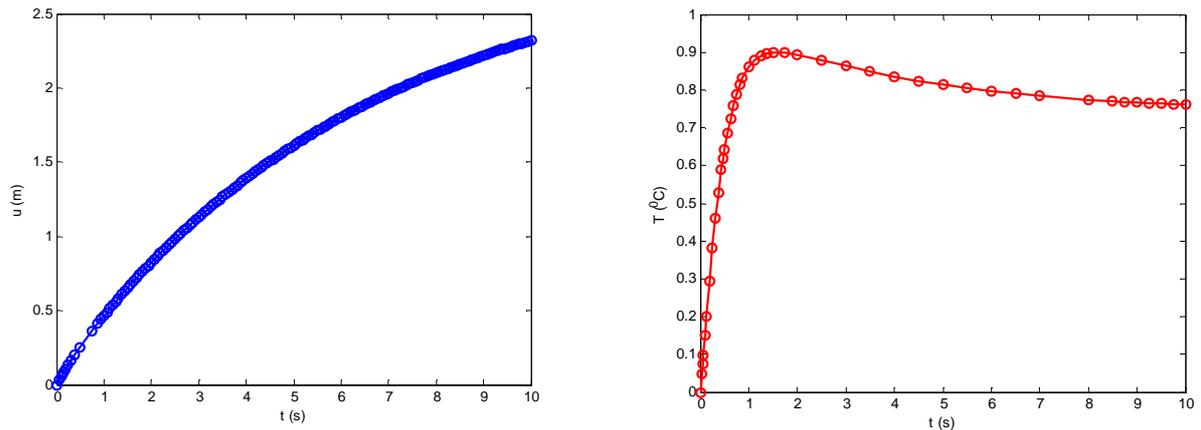
FIG. D.II-9 Evolution du déplacement au point  $x=5$  (gauche) et de la température au point  $x=7$  (droite) en fonction du temps pour l'étape de maillage adaptatif finale
