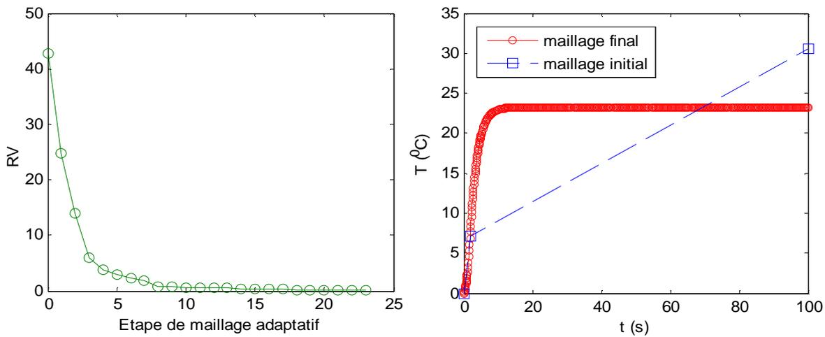
FIG. B.II-9 Evolution du résidu  $RV$  en fonction des étapes de maillage adaptatif (gauche) et évolution de la température au point  $(x,y)=(0,0)$  en fonction du temps (droite) dans le cas RPGD\_S22
