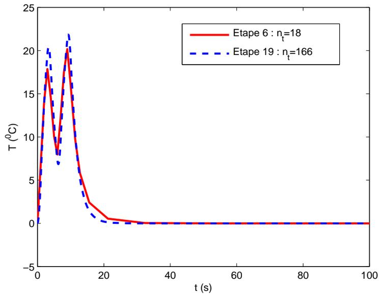
FIG. B.II-14 Evolution de la température au point  $(x,y)=(0,0)$  en fonction du temps à l'étape 6 et à l'étape finale de maillage adaptatif
