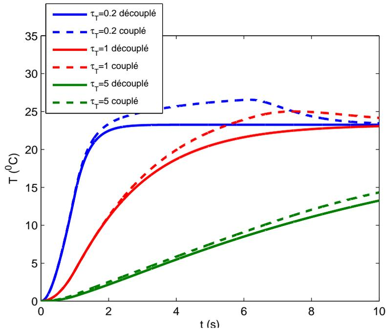
FIG. D.I-7 Cas couplé et cas découplé ( $B_{T_c} = 0.2$ )- Evolution de la température au point  $(x,y)=(0,0)$  pour différentes valeurs de  $\tau_T$
