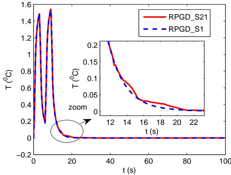
FIG. B.II-16 Evolution de la température au point  $(x,y)=(-2.82,-2.82)$  en fonction du temps obtenue par la RPGD\_S21 et RPGD\_S1
