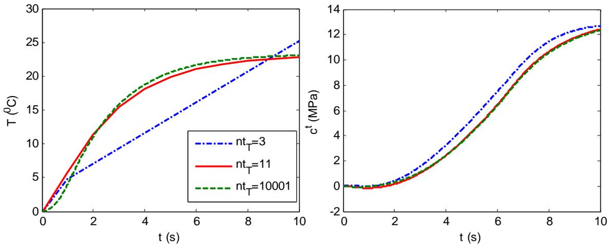
FIG. D.I-5 Evolution de la température (gauche) et de la concentration totale (droite) pour le point  $(x,y)=(0,0)$  pour différents maillages temporels pour la température.
