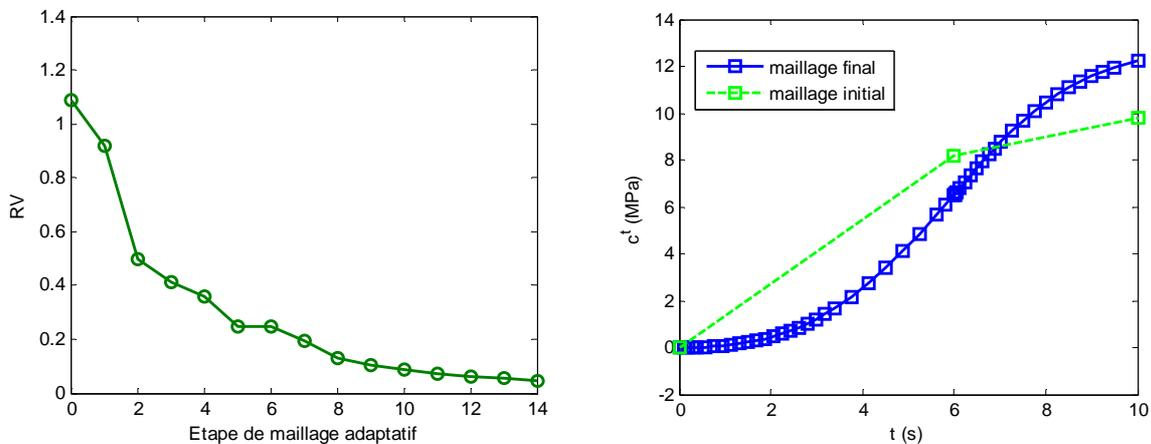
FIG. D.II-1 Evolution du résidu  $RV$  en fonction des étapes de maillages adaptatif (gauche) et évolution de la concentration totale au point  $(x,y)=(0,0)$  en fonction du temps (droite) dans le cas RPGD\_S1
