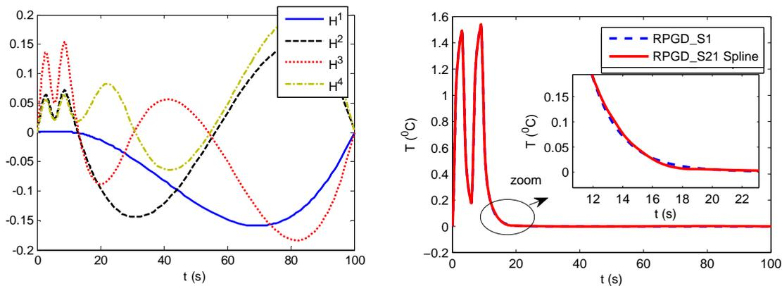
FIG. B.II-17 Quatre premiers modes temporels obtenus dans le cas RPGD\_S21 (gauche). Evolution de la température au point  $(x,y)=(-2.82,-2.82)$  en fonction du temps obtenue par la RPGD\_S21 et RPGD\_S1 (droite) avec une interpolation cubique Spline
