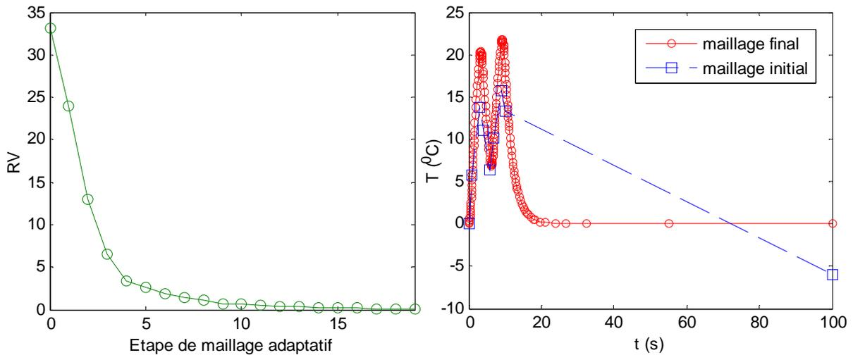
FIG. B.II-10 Evolution du résidu  $RV$  en fonction des étapes de maillage adaptatif (gauche) et évolution de la température au point  $(x,y)=(0,0)$  en fonction du temps (droite) dans le cas RPGD\_S1
