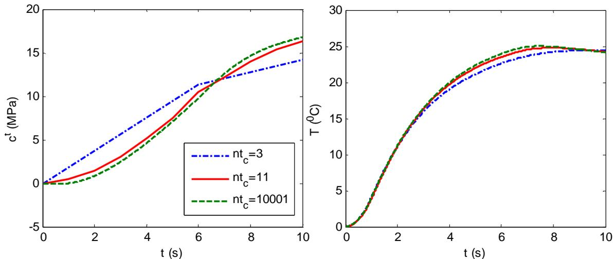
FIG. D.I-8 Evolution de la concentration totale (gauche) et de la température (droite) au point  $(x,y)=(0,0)$  pour différents maillages temporels pour la concentration
