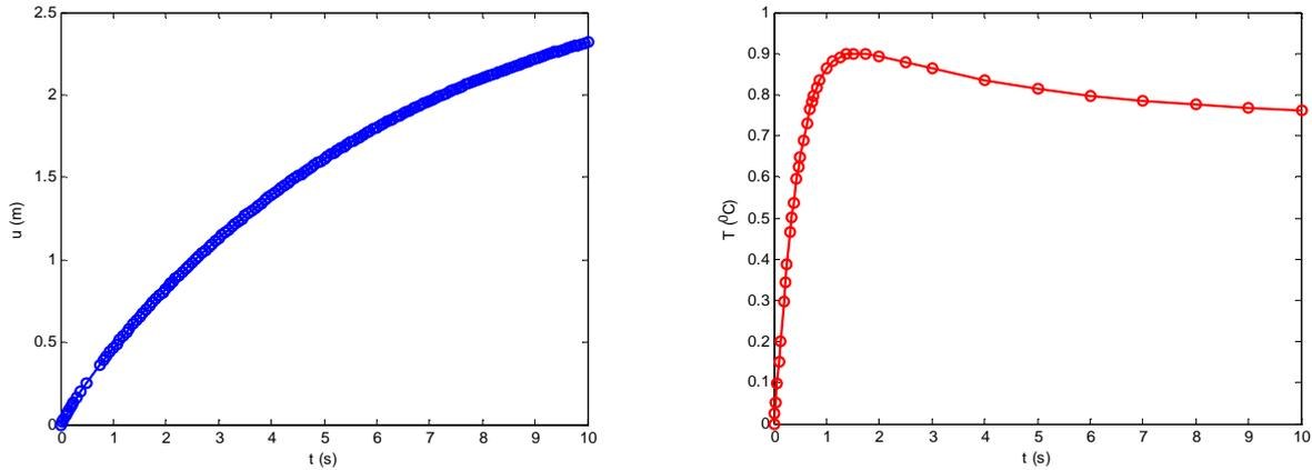
FIG. D.II-14 RPGD\_S22 - Evolution du déplacement au point  $x=5$  (gauche) et de la température au point  $x=7$  (droite) en fonction du temps pour l'étape de maillage adaptatif finale
