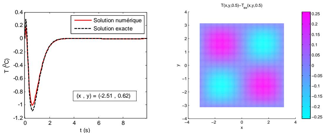
FIG. B.I-2 Evolution de la température en fonction du temps au point  $(x,y)=(-2.51, 0.62)$  pour la solution numérique et la solution exacte (gauche), et carte d'écart en espace au point  $t = 0.5$  (droite)
