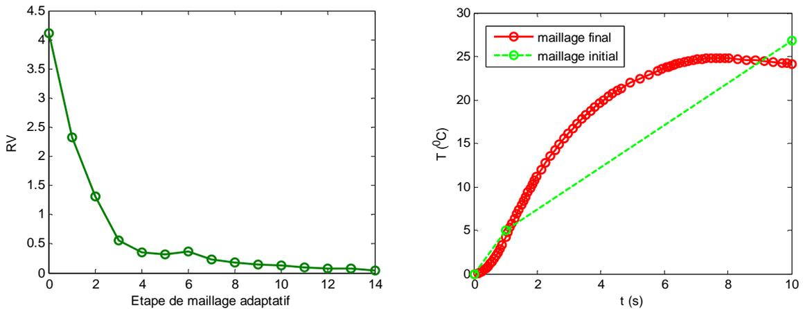
FIG. D.II-4 Evolution du résidu  $RV$  en fonction des étapes de maillage adaptatif (gauche) et évolution de la température au point  $(x,y)=(0,0)$  en fonction du temps (droite) dans le cas RPGD\_S1
