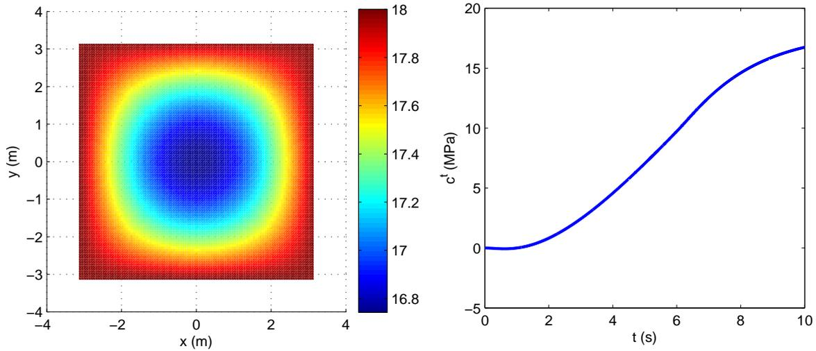
FIG. D.I-2 Cas découplé - Evolution de la concentration totale en espace à  $t=10$  (gauche) et en temps au point  $(x,y)=(0,0)$  (droite)
