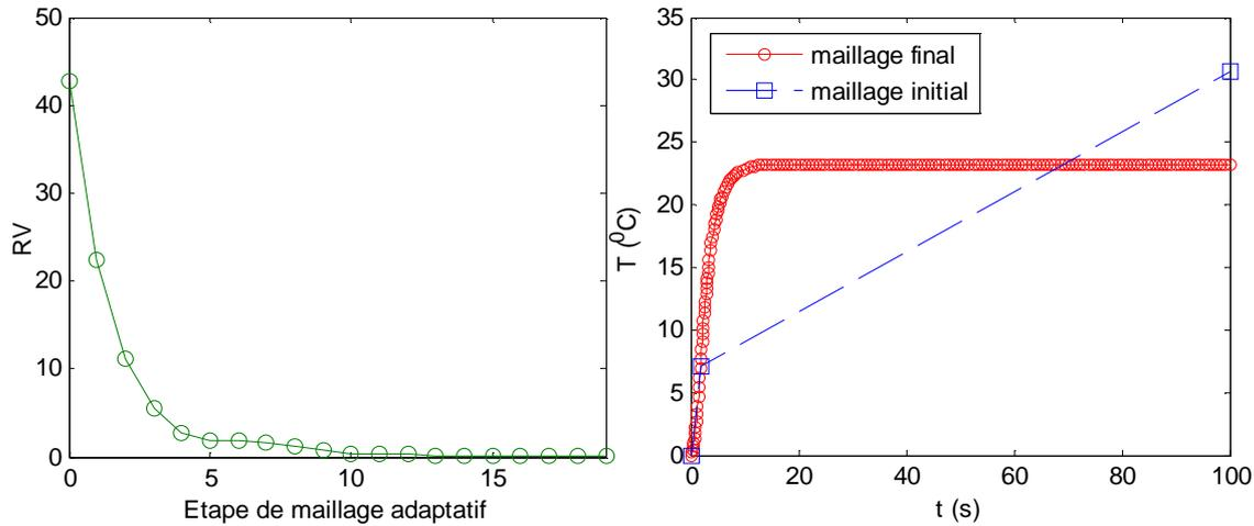
FIG. B.II-6 Evolution du résidu  $RV$  en fonction des étapes de maillage adaptatif (gauche) et évolution de la température au point  $(x,y)=(0,0)$  en fonction du temps (droite) dans le cas RPGD\_S1
