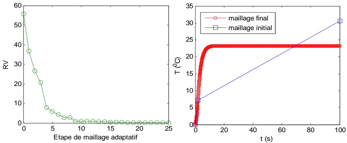
FIG. B.II-8 Evolution du résidu  $RV$  en fonction des étapes de maillage adaptatif (gauche) et évolution de la température au point  $(x,y)=(0,0)$  en fonction du temps (droite) dans le cas RPGD\_S21
