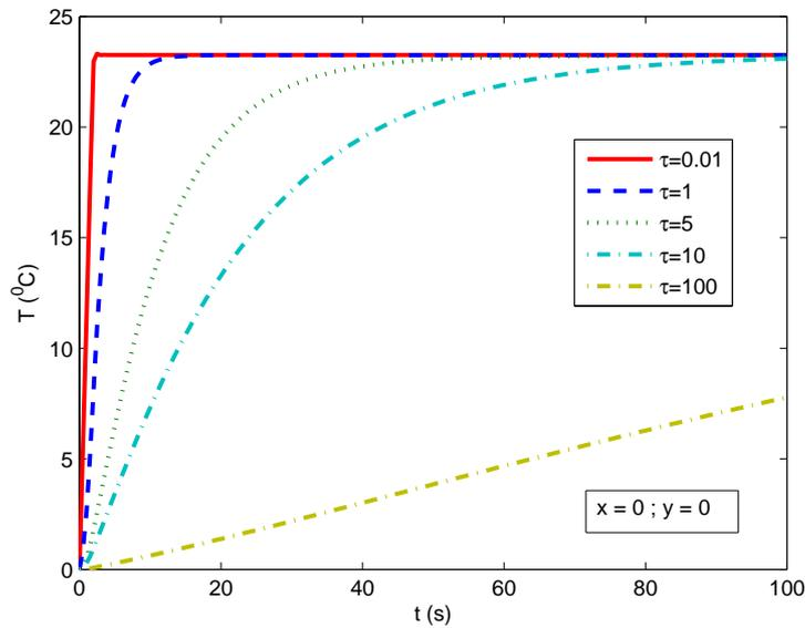
FIG. B.I-7 Evolution de la température en fonction du temps au point  $(x,y)=(0,0)$  pour différentes valeurs de  $\tau$  ( $\lambda_T = 1$  fixé)
