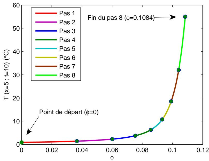
**FIG. D.I-19** L'évolution de la température au point  $(x=5, t=10)$  en fonction de  $\phi$  à l'ordre 15 de la MAN et 8 pas de continuation pour une précision  $\delta = 10^{-6}$
