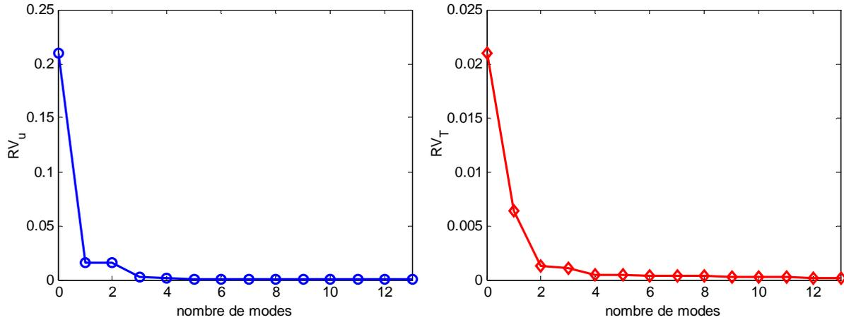
FIG. D.I-18 Evolution du résidu pour le déplacement (à gauche) et la température (à droite) en fonction du nombre de modes pour  $\alpha_{TT} = 0.4$
