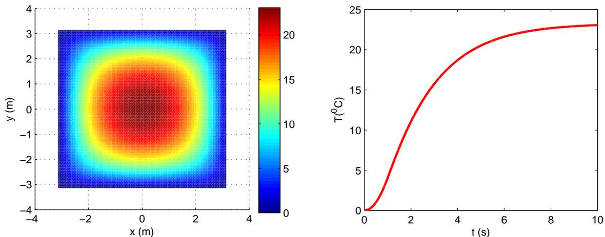
FIG. D.I-1 Cas découplé - Evolution de la température en espace à  $t = 10$  (gauche) et en temps au point  $(x,y)=(0,0)$  (droite)
