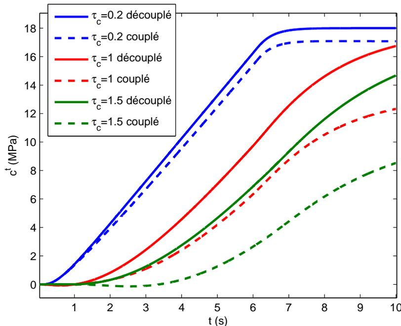
FIG. D.I-4 Cas découplé et couplé ( $A_{cT} = 0.2$ ) - Evolution de la concentration totale au point  $(x,y)=(0,0)$  en fonction du temps pour différentes valeurs de  $\tau_c$
