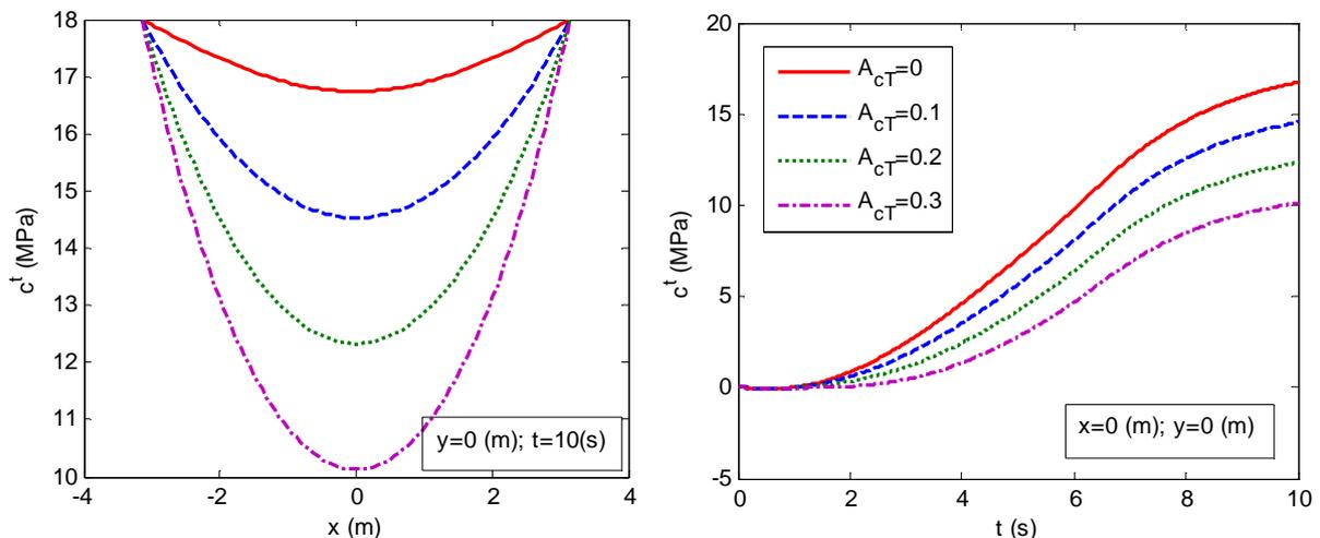
FIG. D.I-3 Evolution de la concentration totale suivant la direction  $x$  ( $y=0$ ,  $t=10$ ) (gauche) et suivant le temps ( $x=0$ ,  $y=0$ ) (droite) pour différentes valeurs du coefficient  $A_{cT}$
