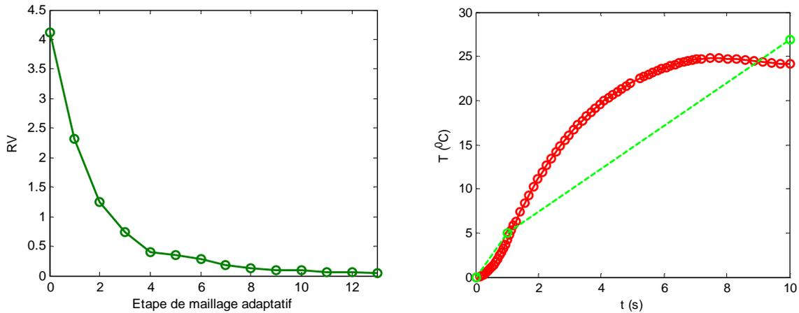
FIG. D.II-6 Evolution du résidu  $RV$  en fonction des étapes de maillage adaptatif (gauche) et évolution de la température au point  $(x,y)=(0,0)$  en fonction du temps (droite) dans le cas RPGD\_S22
