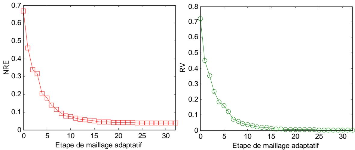
FIG. B.II-3 Evolution de  $NRE$  (gauche) et  $RV$  (droite) en fonction des étapes de maillage adaptatif dans le cas RPGD\_S21
