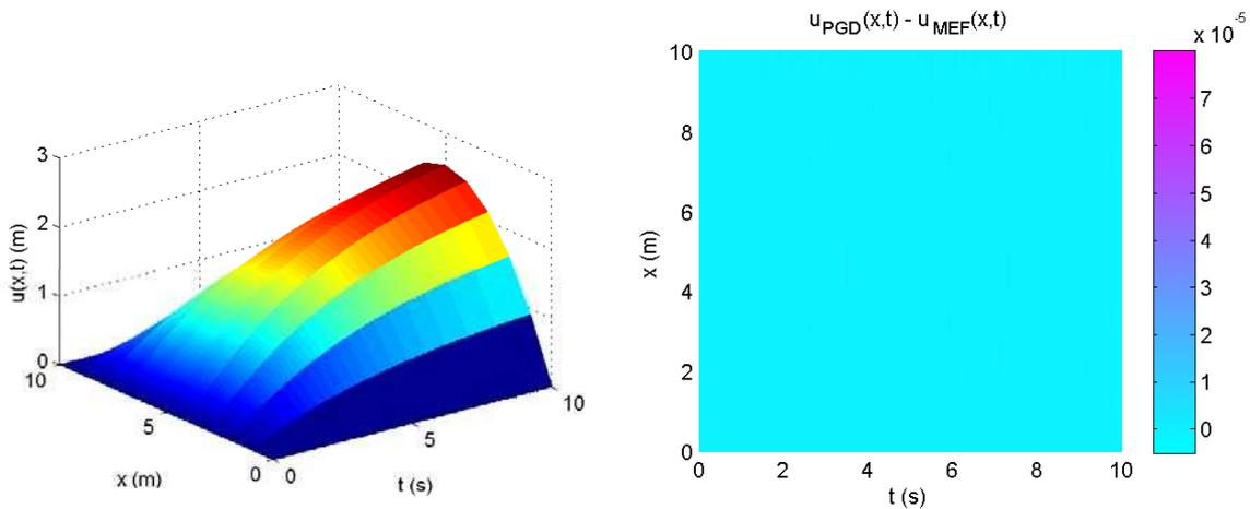
FIG. D.I-12 Solution PGD du déplacement (gauche) et carte d’écart entre la solution PGD et la solution MEF (droite) en espace et en temps
