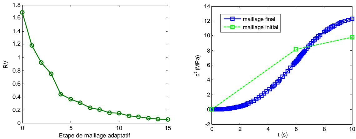
FIG. D.II-2 Evolution du résidu  $RV$  en fonction des étapes de maillage adaptatif (gauche) et évolution de la concentration totale au point  $(x,y)=(0,0)$  en fonction du temps (droite) dans le cas RPGD\_S21
