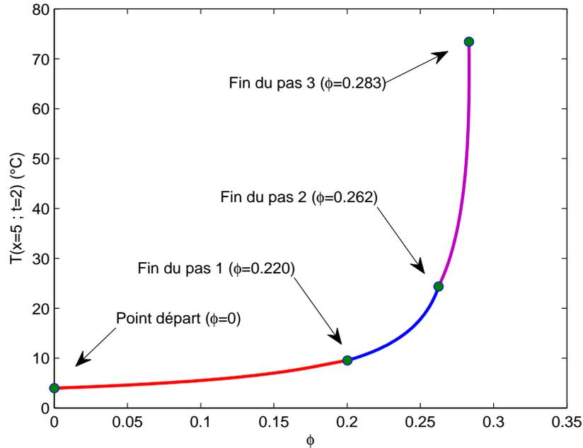
FIG. C.II-19 Evolution de la température au point  $(x=5, t=2)$  en fonction de  $\phi$  à l'ordre 15 de la MAN pour 3 pas de continuation déterminés par  $\delta = 10^{-4}$
