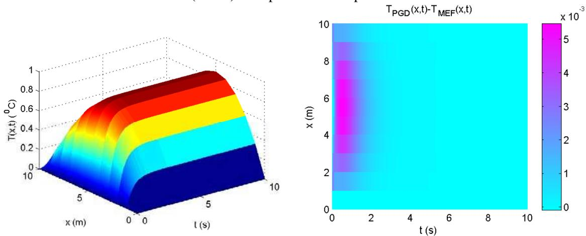
FIG. D.I-13 Solution PGD de la température (gauche) et carte d’écart entre la solution PGD et MEF (droite) en espace et en temps
