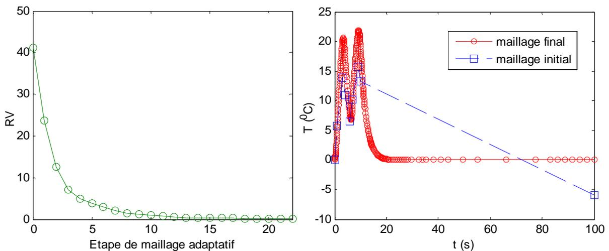
FIG. B.II-11 Evolution du résidu  $RV$  en fonction des étapes de maillage adaptatif (gauche) et évolution de la température au point  $(x,y)=(0,0)$  en fonction du temps (droite) dans le cas RPGD\_S21
