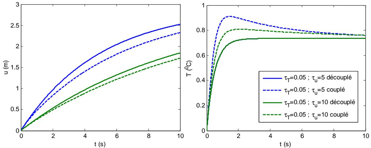
FIG. D.I-20 Cas couplé et découplé. Evolution du déplacement à  $x=5$  (à gauche) et de la température à  $x=7$  (à droite) découplé pour différentes valeurs de  $\tau_u$  à  $\tau_T$  fixée
