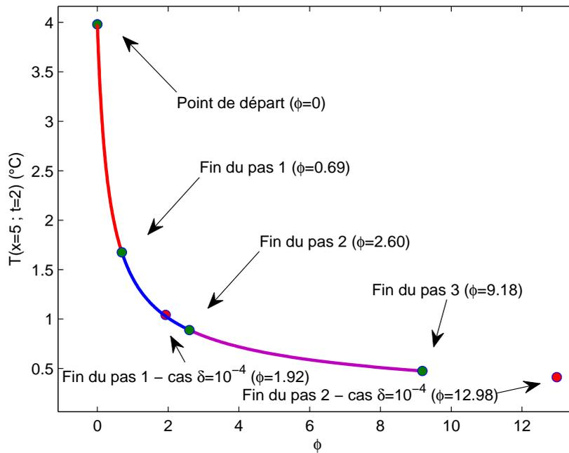
FIG. C.II-17 Evolution de la température au point  $(x = 5, t = 2)$  en fonction de  $\phi$  à l'ordre 15 de la MAN pour 3 pas de continuation déterminés par  $\delta = 10^{-6}$
