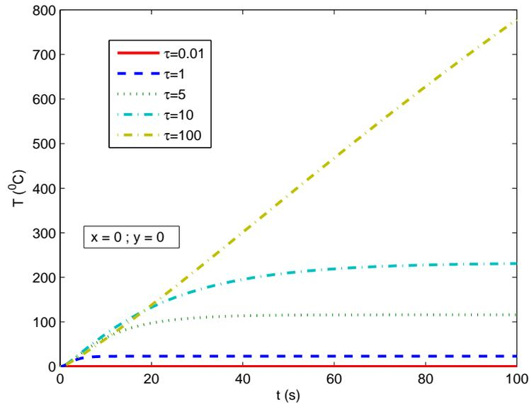
FIG. B.I-8 Evolution de la température au point  $(x,y)=(0,0)$  en fonction du temps pour différentes valeurs de  $\tau$  ( $\rho C = 1$  fixé)
