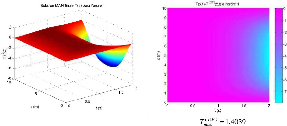
FIG. C.II-8 Solution MAN finale (gauche) et carte d'écart entre la solution MAN finale et la solution DF (droite) à l'ordre 1
