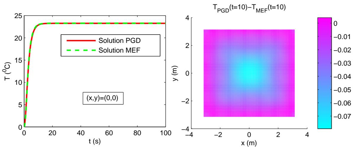
FIG. B.I-6 Evolution de la température en fonction du temps au point  $(x,y)=(0,0)$  pour la solution PGD et pour la solution MEF (gauche) et écart entre deux solutions à  $t=10$  (droite)
