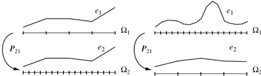
FIG. A.II-2 Exemple de transfert des données entre maillages utilisant des opérateurs de collocation [Dureisseix 2006]
