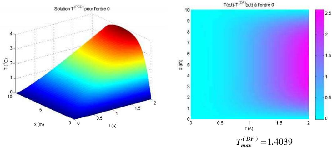
FIG. C.II-3 Solution PGD à l'ordre 0 (gauche) et carte d'écart entre la solution MAN finale à l'ordre 0 et la solution DF (droite)
