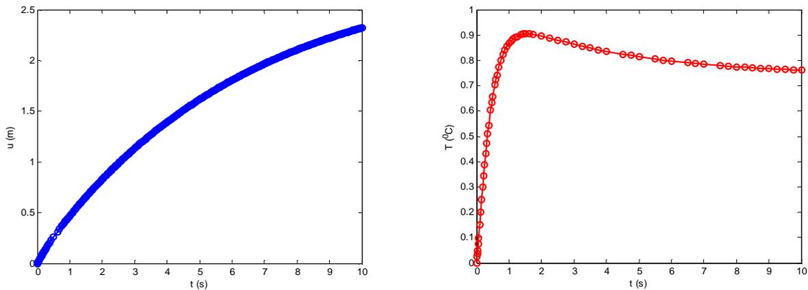
FIG. D.II-13 RPGD\_S21 - Evolution du déplacement au point  $x=5$  (gauche) et de la température au point  $x=7$  (droite) en fonction du temps pour l'étape de maillage adaptatif finale
