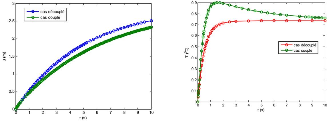
FIG. D.II-10 Cas couplé et découplé. Evolution du déplacement au point  $x=5$  (gauche) et de la température au point  $x=7$  (droite) en fonction du temps pour l'étape de maillage adaptatif finale
