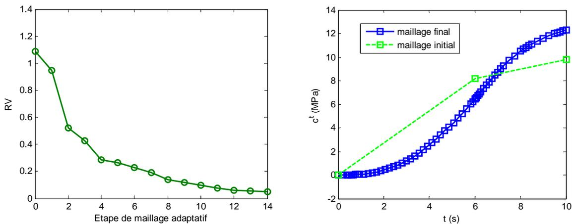
FIG. D.II-3 Evolution du résidu  $RV$  en fonction des étapes de maillage adaptatif (gauche) et évolution de la concentration totale au point  $(x,y)=(0,0)$  en fonction du temps (droite) dans le cas RPGD\_S22
