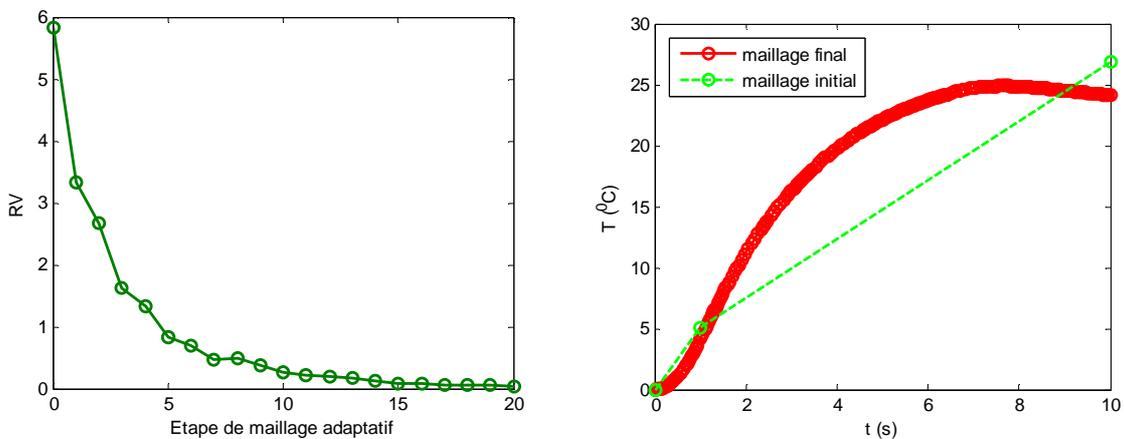
FIG. D.II-5 Evolution du résidu  $RV$  en fonction des étapes de maillage adaptatif (gauche) et évolution de la température au point  $(x,y)=(0,0)$  en fonction du temps (droite) dans le cas RPGD\_S21
