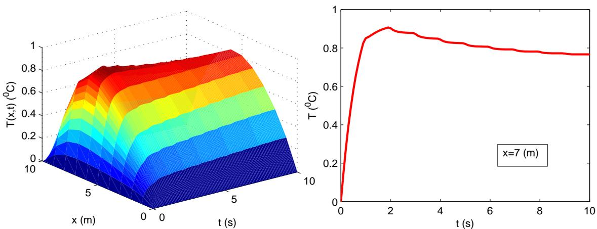
**FIG. D.I-24** Maillage  $nt_u = 11, nt_T = 101$ . Solution de la température en fonction de l’espace et du temps (gauche). Evolution de la température pour un point  $x=7$  en fonction du temps (droite)
