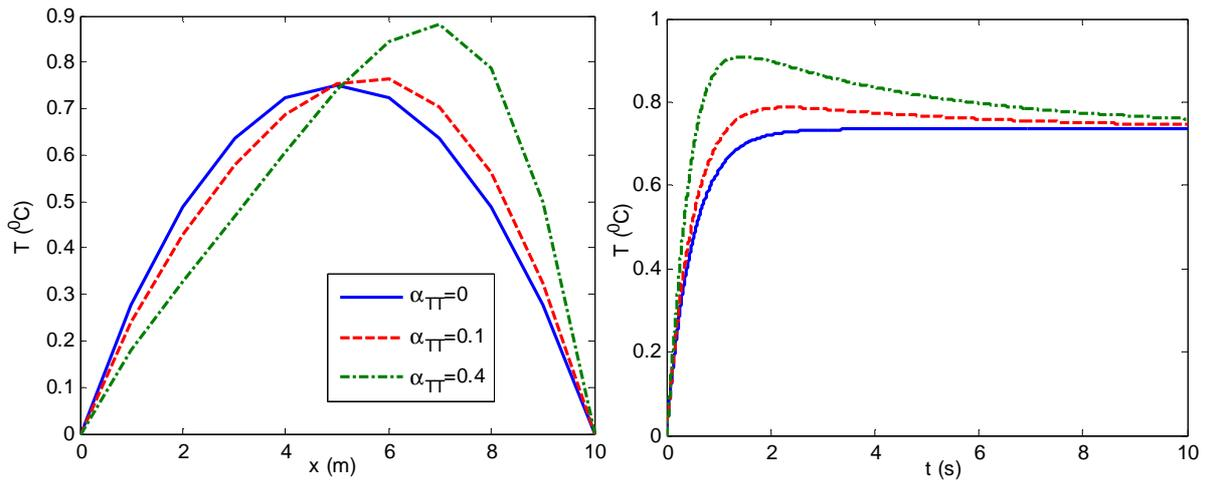
FIG. D.I-16 Evolution de la température en fonction de l’espace (à gauche) à  $t=10$  et en fonction du temps (à droite) à  $x=7$  pour différentes valeurs de  $\alpha_{TT}$
