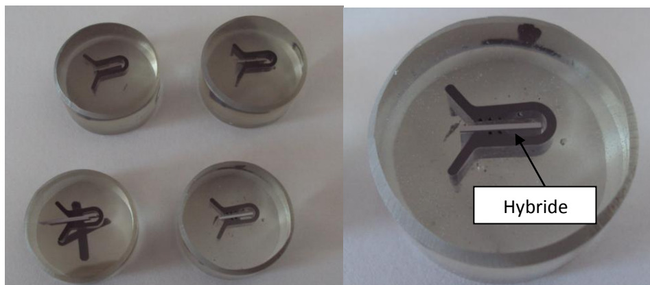
Figure 85 : Illustration microscopique d'un hybride maintenu dans la résine pour des observations MEB en micro section.
