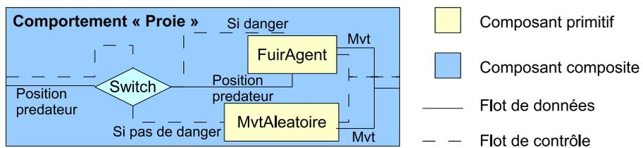
FIGURE 3.6 – Exemple d'architecture d'agent réactif avec MALEVA.
