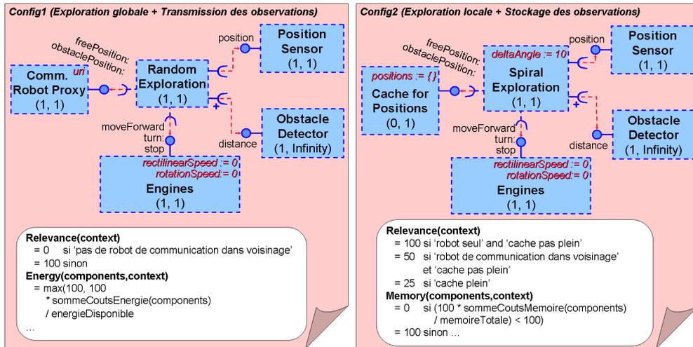
FIGURE 6.19 – Deux des configurations pour un robot d'exploration.
