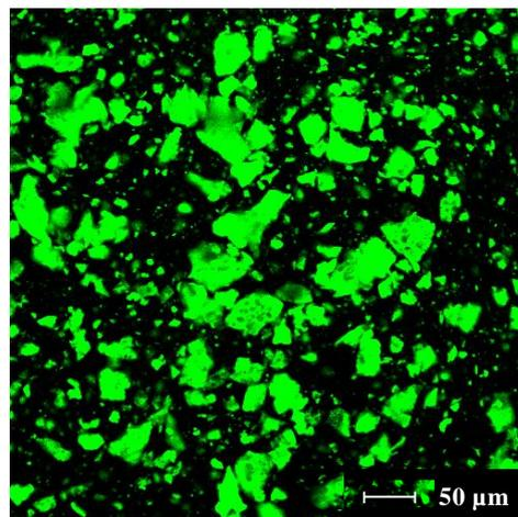
Figure 111 : Image de microscopie confocale du nanocomposite PVP/BAM:Eu<sup>2+</sup> ( $\lambda_{exc}=405nm$ )
