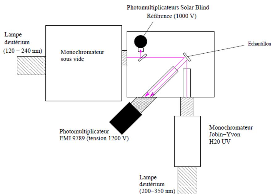
Figure 133 : Schéma de l'enceinte expérimental VUV du LPCML
