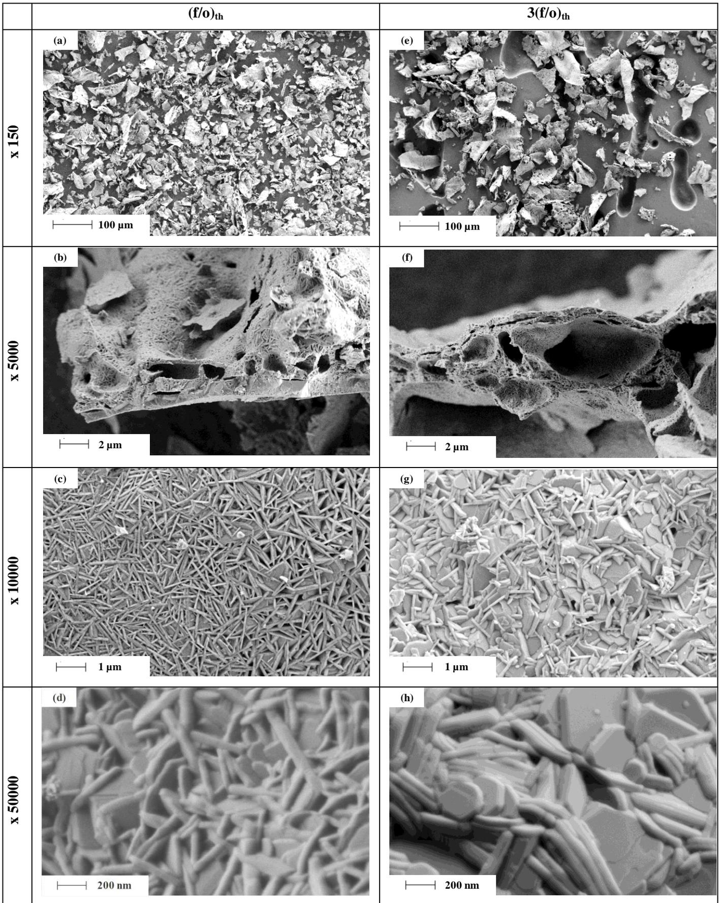
Figure 83 : Images MEB pour les poudres émettant dans le bleu obtenues pour  $(f/o)_{th}$  et  $3(f/o)_{th}$
