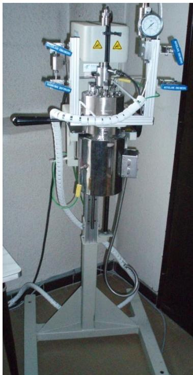
Figure 38 : Photo de l'autoclave de 1L
