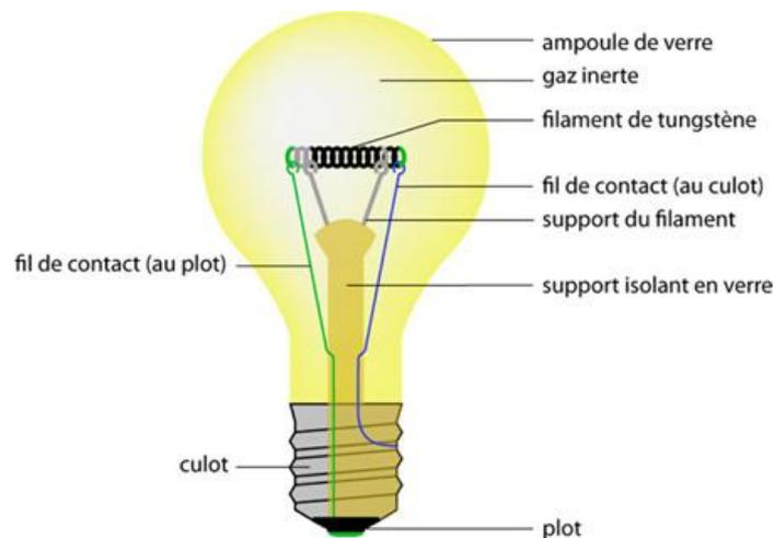
Figure 5 : Schéma de principe d'une ampoule à incandescence
