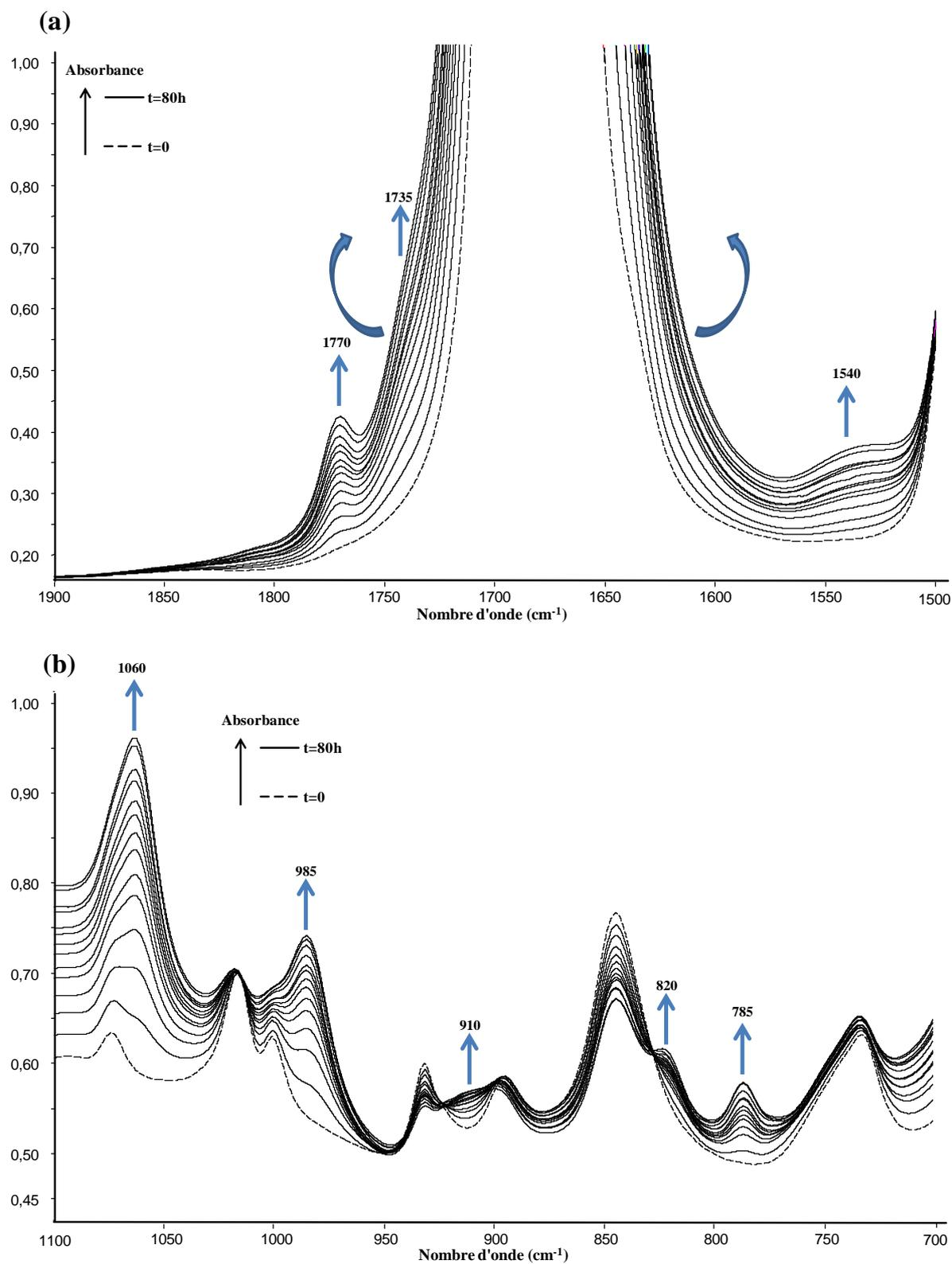
Figure 113 : Spectres IR entre (a) 1900-1500 cm<sup>-1</sup> et (b) 1100-700 cm<sup>-1</sup> du film de PVP vierge au cours de la photooxydation
