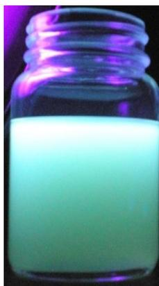
Figure 40 : Photo d'une suspension de YAG :Ce (1%) en sortie de réacteur
