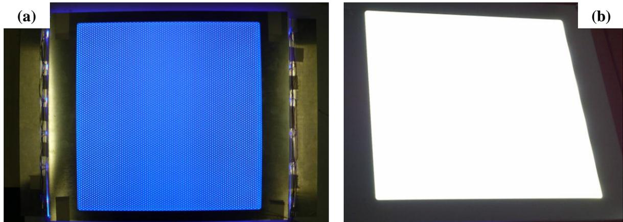
Figure 124 : Photos du démonstrateur D2 (a) sans et (b) avec la couche de luminophores
