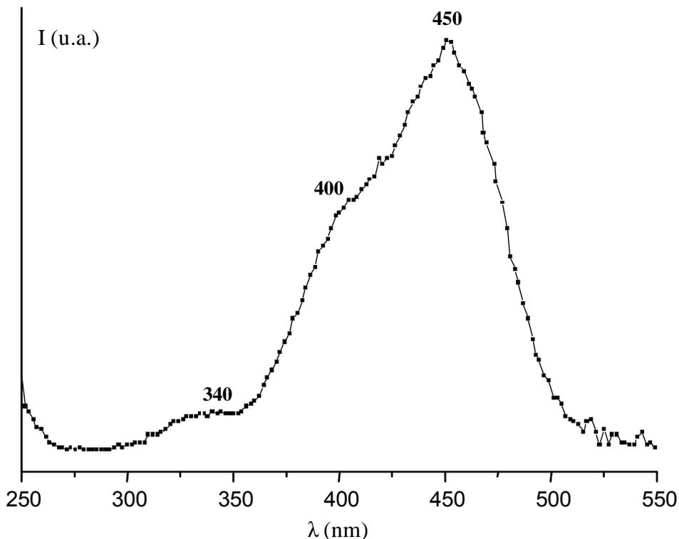
Figure 62 : Spectre d'excitation de la poudre de YAG :Ce (1%) résultant de la suspension étuvée à 80°C
