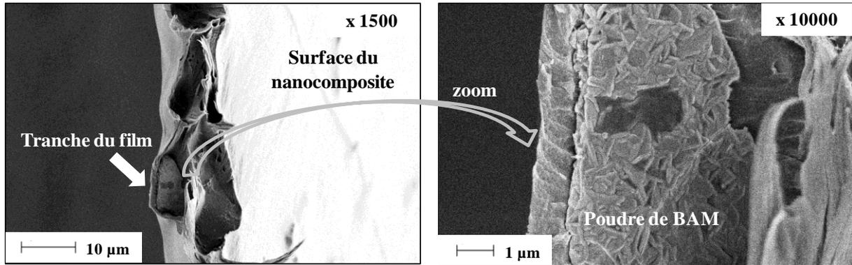
Figure 110 : Images MEB du nanocomposite PVP/BaMgAl<sub>10</sub>O<sub>17</sub>:Eu<sup>2+</sup>
