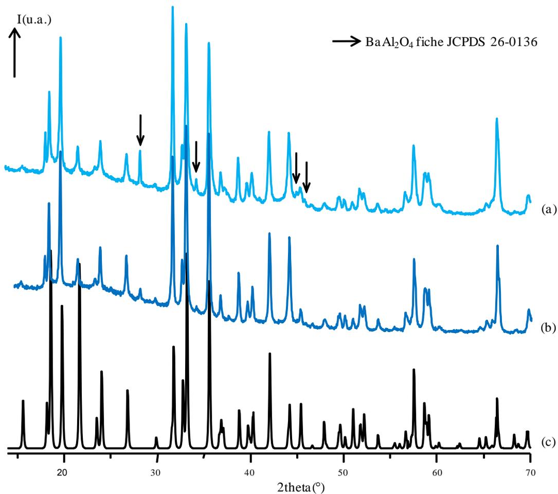
Figure 79 : Diffractogrammes X des poudres émettant dans le bleu obtenues pour (a)  $(f/o)_{th}$ , (b)  $3(f/o)_{th}$  et (c) le diffractogramme simulé pour BAM :Eu<sup>2+</sup>
