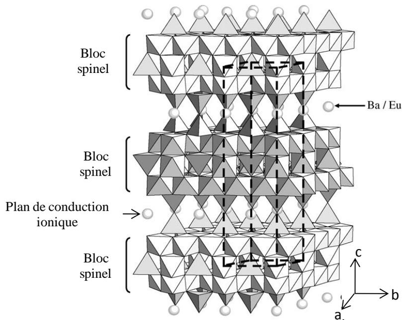
Figure 34 : Structure cristallographique du BAM :Eu
