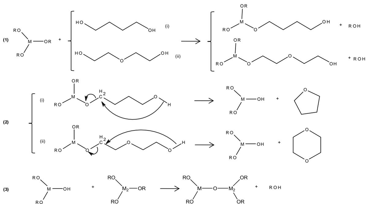
Figure 39 : Formation des liaisons M-O-M<sub>2</sub> (M,M<sub>2</sub>=Al,Y ou Ce) au cours du procédé glycothermal
