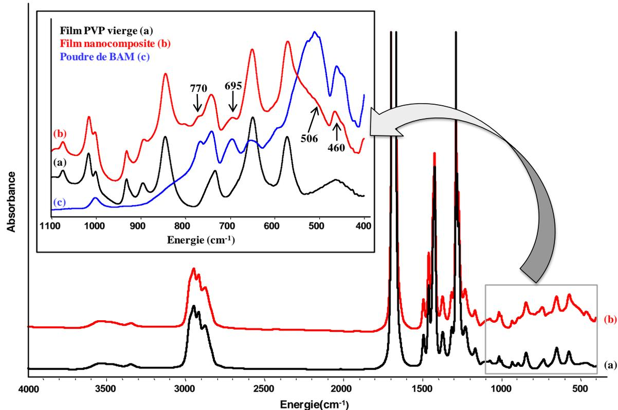
Figure 107 : Spectres infrarouge de (a) film PVP vierge, (b) film nanocomposite PVP/BaMgAl<sub>10</sub>O<sub>17</sub>:Eu<sup>2+</sup> et zoom de comparaison entre films/ poudre de BAM :Eu en encart
