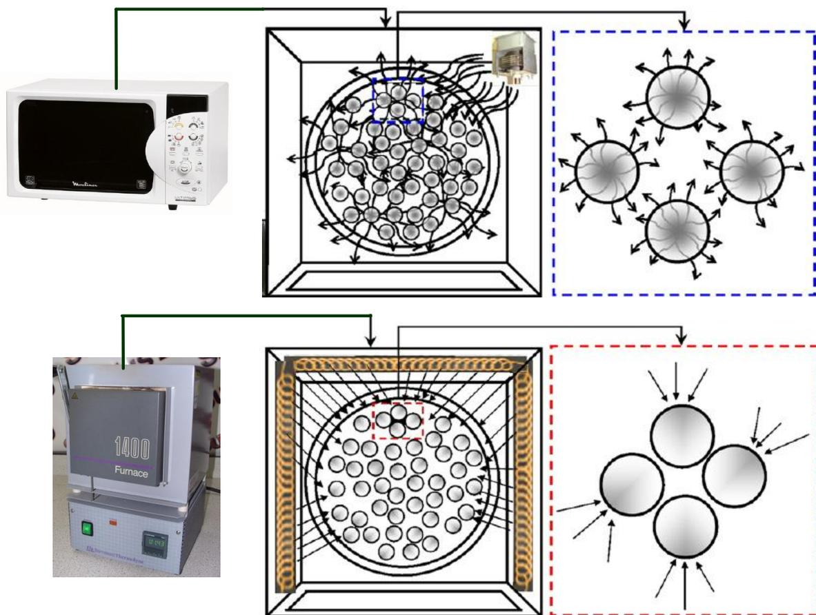
Figure 36 : Direction du flux de chaleur lors d'un chauffage dans un four micro-ondes ou dans un four à moufle
