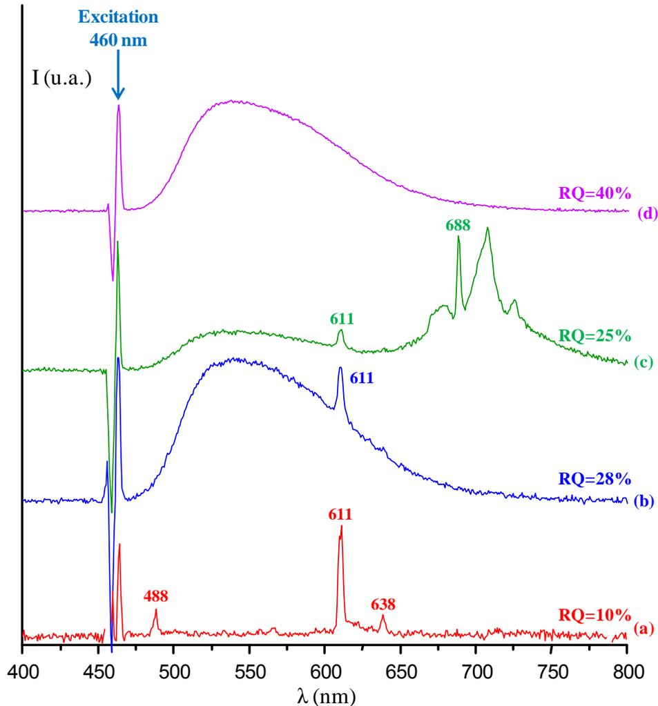
Figure 68 : Spectres d'émission et rendements quantiques des poudres de (a) YAG :Pr, (b) YAG :Ce,Pr, (c) YAG :Ce,Pr,Cr et (d) YAG :Ce sous excitation bleue (460 nm)
