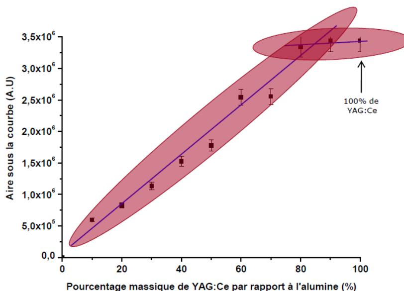
Figure 120 : Luminescence observée en fonction du pourcentage massique de YAG:Ce(1%) par rapport à l'alumine
