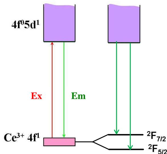
Figure 32 : Schéma du diagramme des niveaux d'énergie de Ce<sup>3+</sup> dans la matrice YAG
