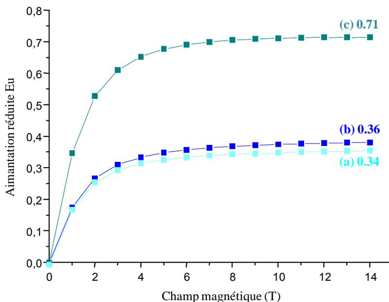
Figure 87 : Aimantation réduite en fonction du champ magnétique à 3,5K pour les poudres émettant dans le bleu obtenues pour  $3(f/o)_{th}$  (a) avant lavage, (b) après lavage et (c) après réduction (les chiffres indiqués sur les courbes représentent la fraction d'euprium divalent)
