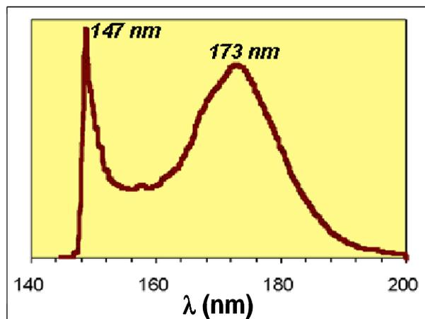
Figure 22 : Spectre d'émission caractéristique d'un plasma Ne-Xe
