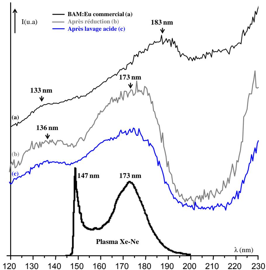
Figure 100 : Spectres d’excitation des poudres bleues purifiées – comparaison avec une poudre commerciale
