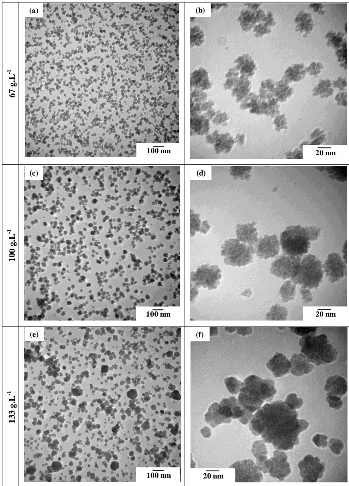
Figure 56 : Images MET des suspensions obtenues pour un taux de charge de (a,b) 67 g.L<sup>-1</sup>, (c,d) 100 g.L<sup>-1</sup> et (e,f) 133 g.L<sup>-1</sup>
