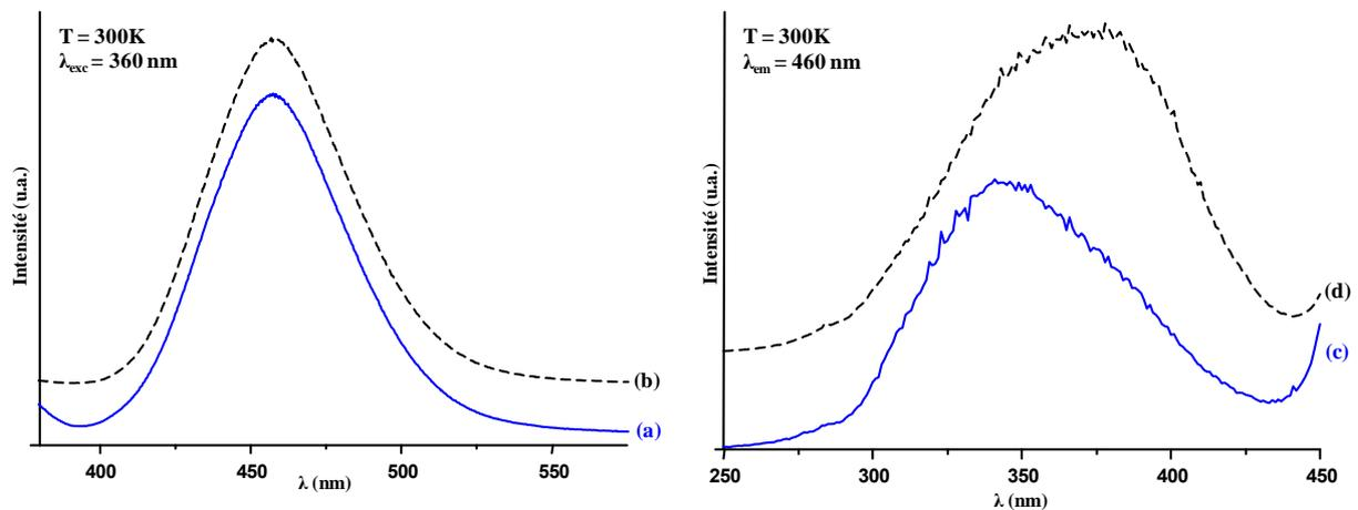
Figure 112 : Spectres d'émission (a,b) et d'excitation(c,d) pour le nanocomposite PVP/BAM:Eu<sup>2+</sup> (a,c) et pour la poudre BAM :Eu (b,d)
