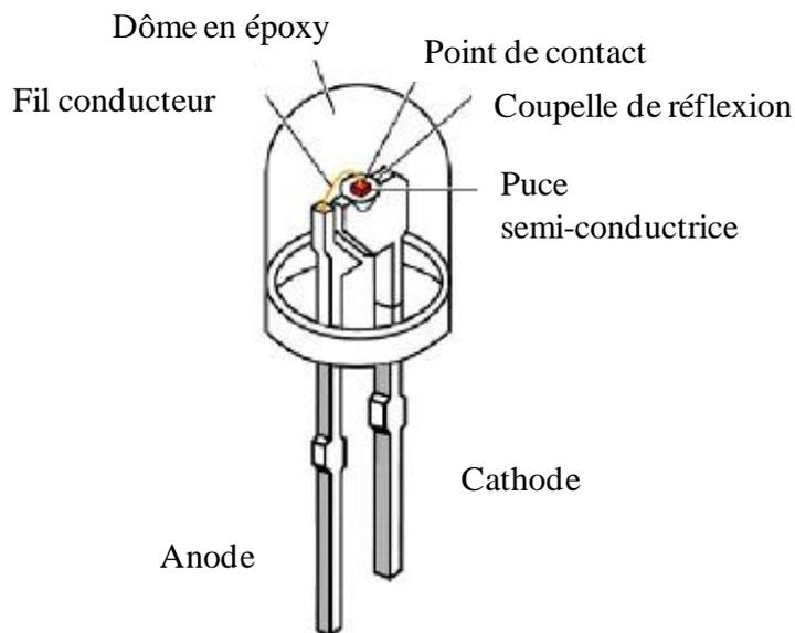
Figure 16 : Schéma de principe d'une LED type 5mm
