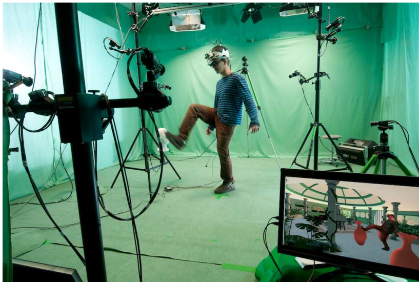
FIGURE 1.5 – Le projet Virtualization Gate permet de plonger un utilisateur et son avatar 3D dans un monde virtuel. Ici le modèle de l'utilisateur est reconstruit et intégré en temps-réel dans le monde virtuel. Les interactions sont ensuite calculées avec les objets ce qui permet ici à l'utilisateur de renverser le vase avec son pied. La vue en bas à droite est une vue déportée du monde virtuel. Le casque muni de lunettes-écran permet à l'utilisateur d'avoir un point de vue cohérent avec sa position dans le monde réel.
