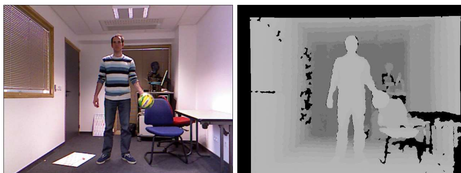
FIGURE 2.1 – La même scène vue par une caméra couleur et une caméra de profondeur, deux types de capteurs communs.
