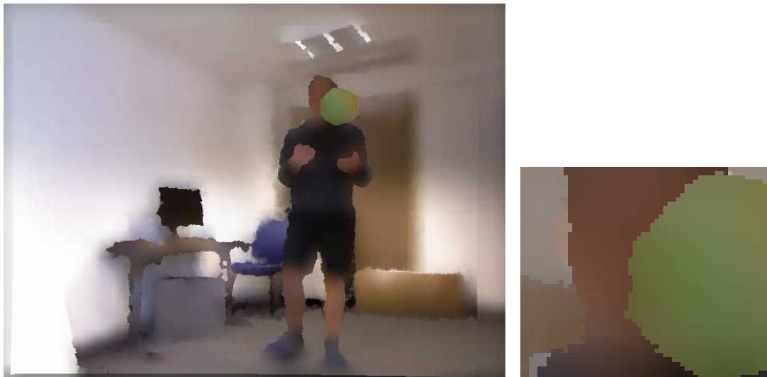
(d) Filtre bilatéral utilisant l'information de profondeur \sigma_r = 0.03, \sigma_s = 15
