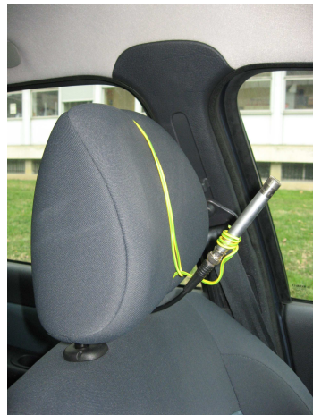
Figure 22. Position du microphone pour les mesures acoustiques
