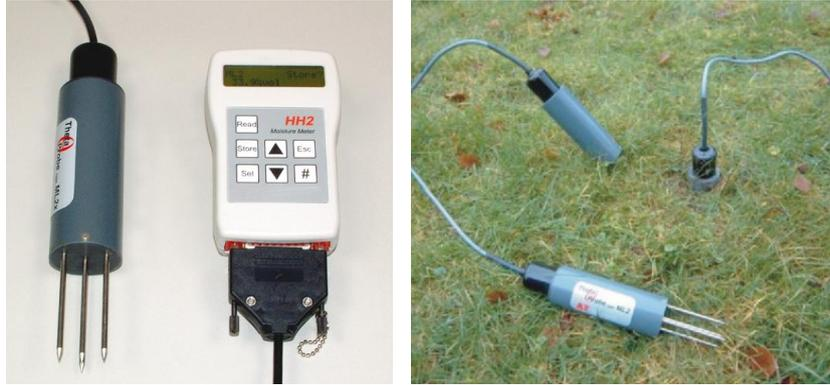
FIGURE 1.4 – Theta Probe : instrument permettant de calculer l’humidité du sol à travers la mesure de la constante diélectrique du sol.
