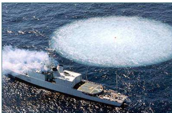
FIG. 1.1: Essai de choc sur navire (source : www.martec.com ).
